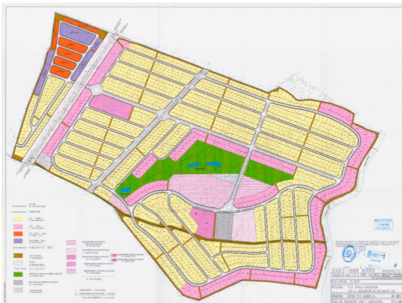
Figura 33. Aldeamayor de San Martín. Plan parcial Sector 12 (El Soto). Plano de ordenación, usos y alineaciones. Fuente: PLAU, id. 281550.
