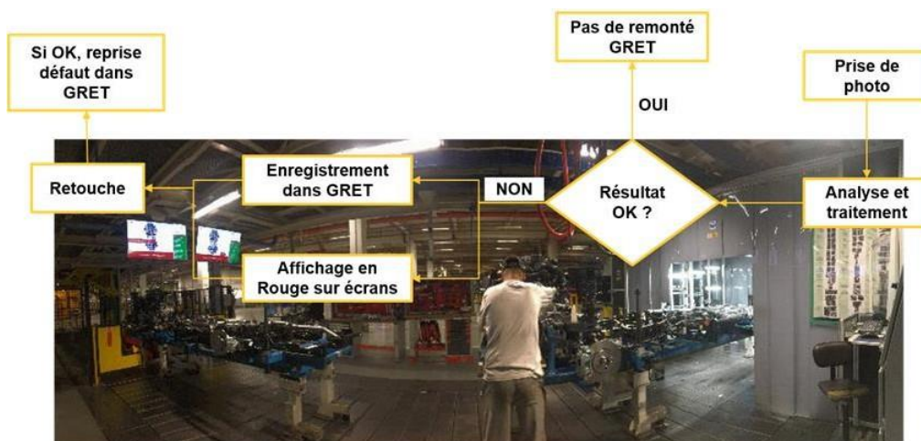
Figure 24 : Schéma fonctionnement du tunnel contrôle par vision
