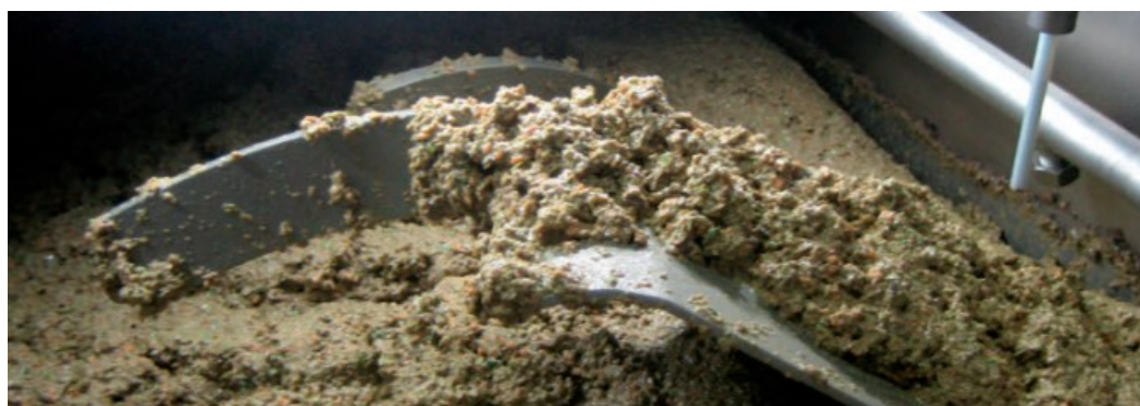
IMAGEN DE BATIDO DE LA PASTA DE ACEITUNA PREVIAMENTE MOLIDA
