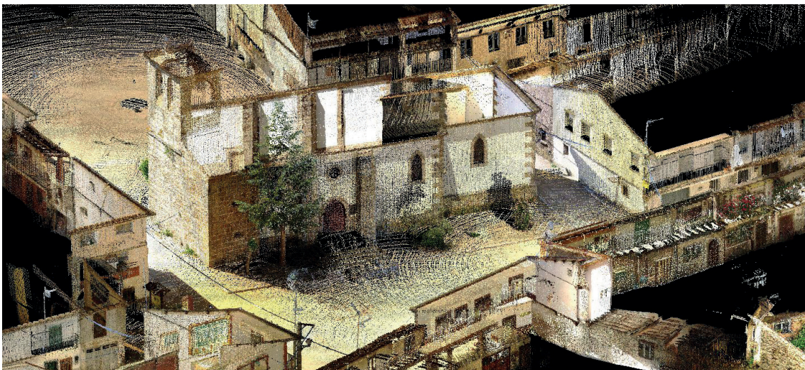
Figura 250. Nube de puntos de la zona de la plaza y la iglesia de Nuestra Señora de la Asunción. Fuente: elaboración propia
