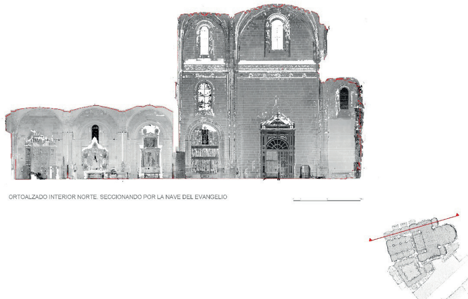
Figura 279. Sección obtenida a partir del modelo de nubes de puntos. Fuente: elaboración propia
