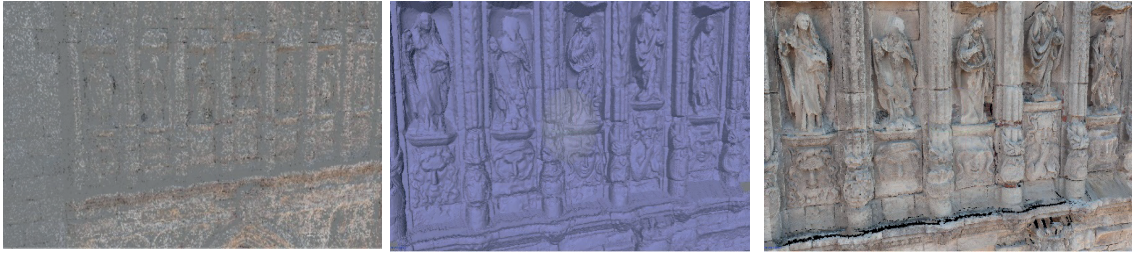
Figura 19. Imágenes de las diferentes fases del proceso de fotogrametría. De izquierda a derecha: nube de puntos paso o de orientación, malla de triángulos monocroma y malla de triángulos con textura
