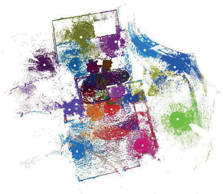
Figura 226. Modelo completo de nube de puntos como resultado del registro de todos los escaneos. Fuente: elaboración propia
