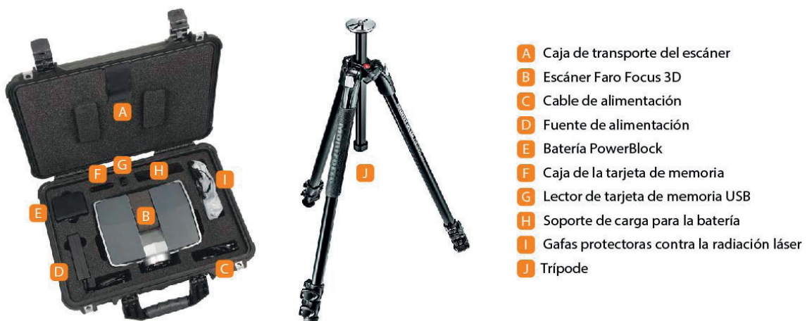
Figura 45. Contenido del equipo básico del escáner láser Faro. Fuente: elaboración propia
