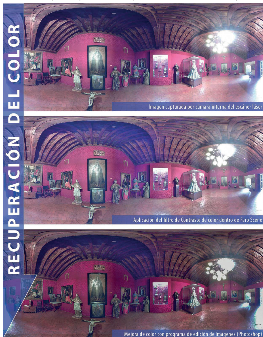
Figura 100. Proceso de recuperación de color de la fotografía original capturada por el escáner láser. Fuente: elaboración propia
