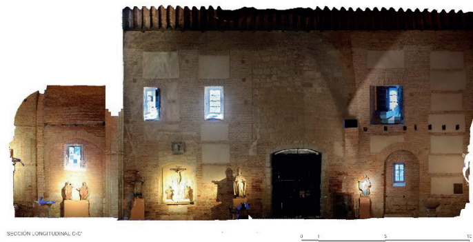
Figura 165. Secciones longitudinales generadas a partir del modelo de fotogrametría
