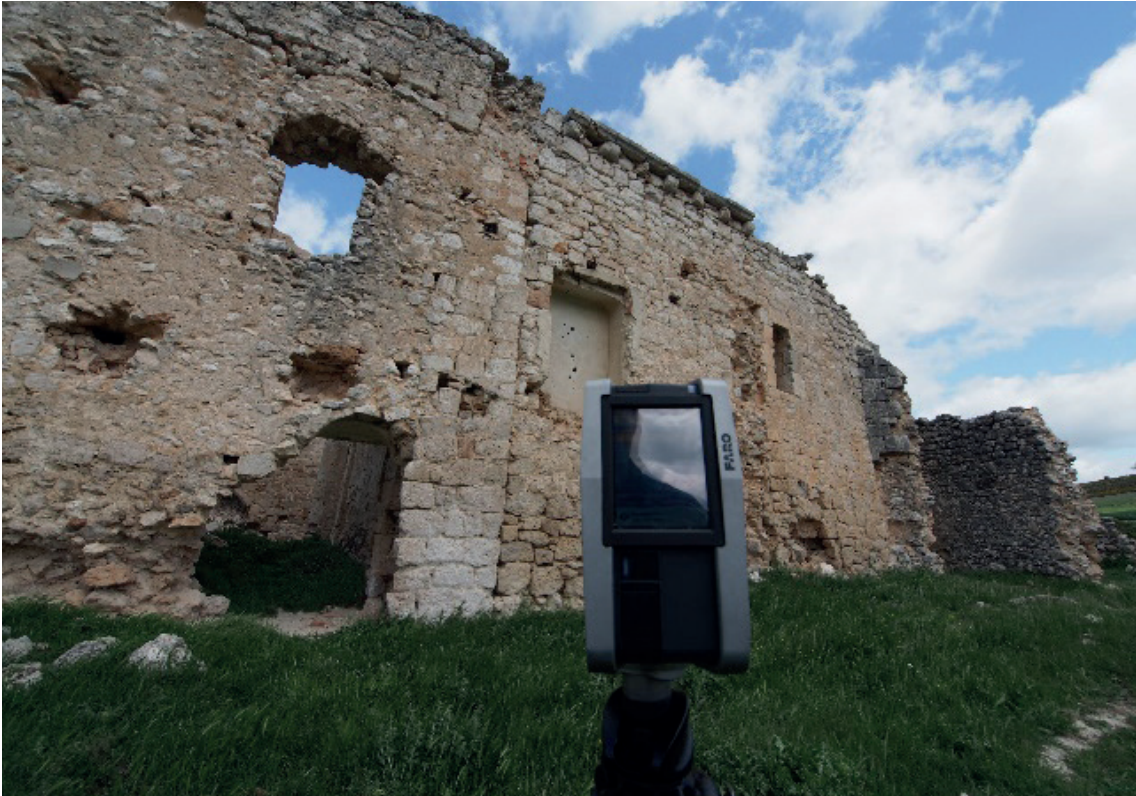
Figura 224. Fotografía del escáner durante el proceso de captura de datos. Fuente: elaboración propia
