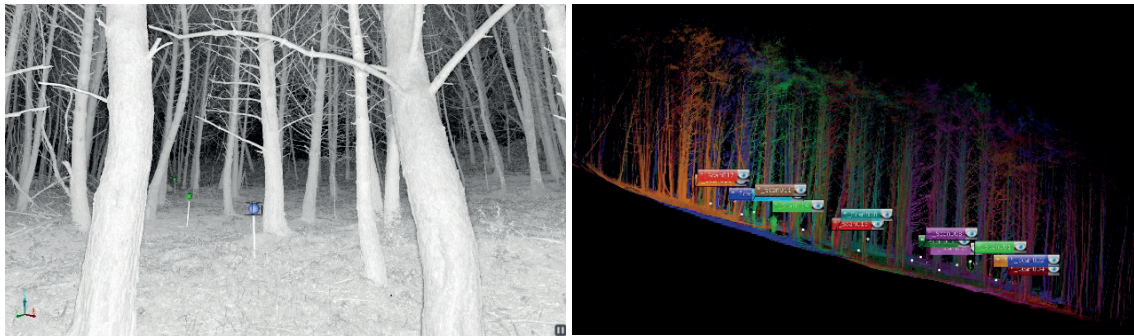
Figura 49. Ejemplo de colocación de referencias artificiales elevadas del suelo debido a las características físicas del caso de estudio. Fuente: elaboración propia
