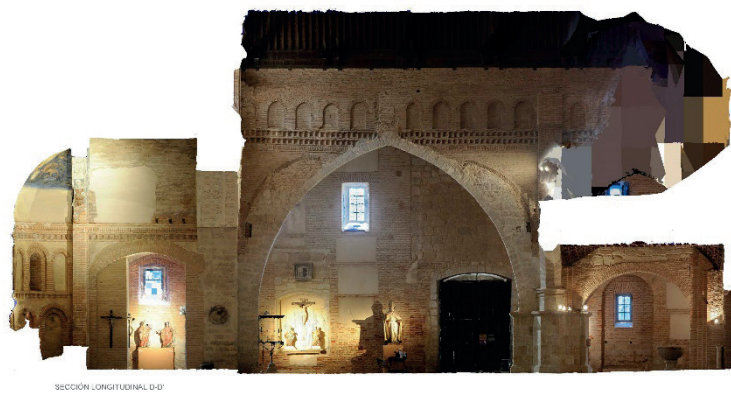
Figura 166. Secciones longitudinales generadas a partir del modelo de fotogrametría
