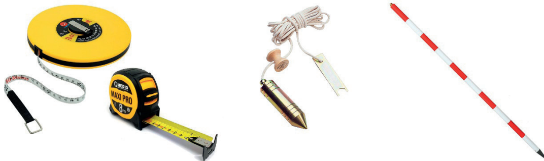
Figura 5. Herramientas de medición tradicionales. De izquierda a derecha: cinta métrica y flexómetro, plomada y jalón. Ilustración propia
