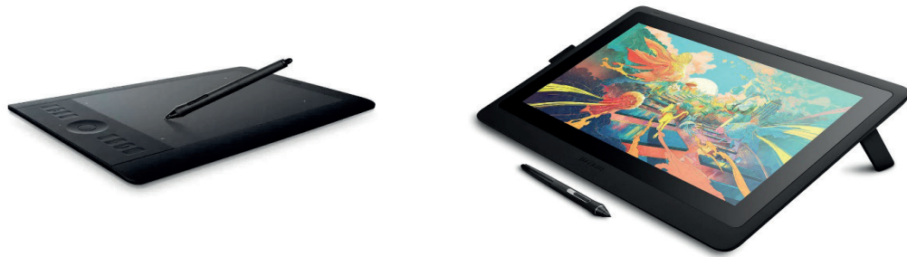
Figura 9. La realización del dibujo digital se asemeja más al tradicional gracias a la evolución de las tabletas gráficas. A la izquierda una de las primeras tabletas en las que se dibujaba en una superficie pero el dibujo se visualizaba en una pantalla externa. A la derecha una tableta con pantalla integrada, lo que facilita el dibujo ya que la posición de la punta del lapicero coincide con el trazo dibujado. Imágenes de www.wacom.com [Consultado: 12/02/2018]
