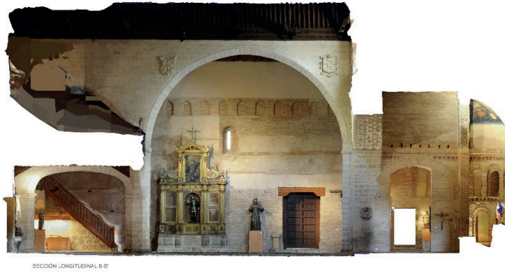
Figura 165. Secciones longitudinales generadas a partir del modelo de fotogrametría
