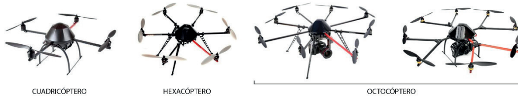
Figura 38. Diferentes configuraciones de multicopteros. Fuente: www.mikrokopter.de [Consultado: 04/08/2018]
