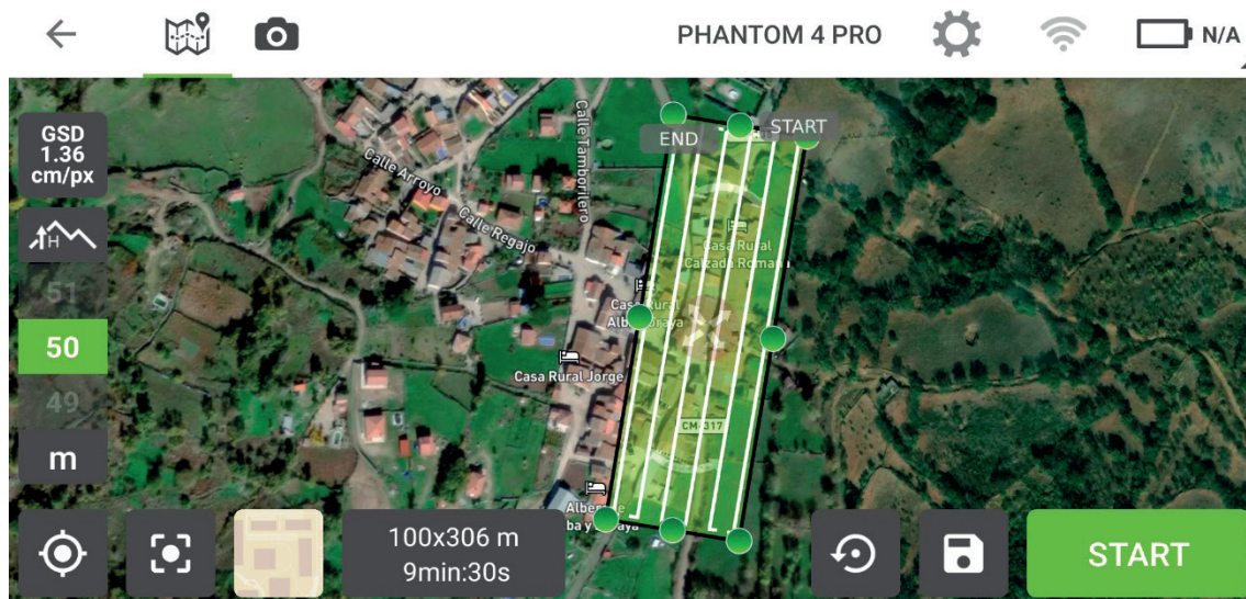
Figura 248. Configuración del plan de vuelo en la aplicación Pix4D Capture. Fuente: elaboración propia
