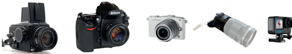
Figura 11. Evolución de los equipos fotográficos. De izquierda a derecha: cámara métrica Hasselblad 500c; cámara réflex digital SLR Nikon D700, cámara micro cuatro tercios Olympus EPM1, cámara sin pantalla Olympus AIR, micro cámara foto/vídeo GoPro Hero 10. Fuente: elaboración propia
