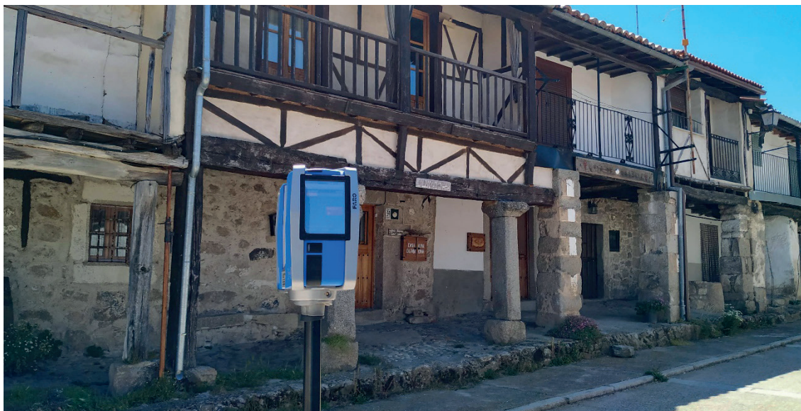
Figura 245. Toma de datos con el escáner Faro Focus 3D. Fuente: elaboración propia
