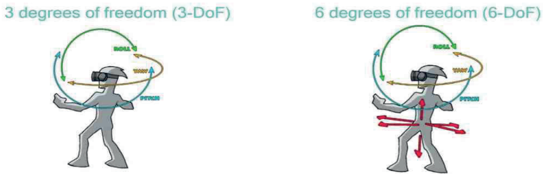
Figura 141. Esquema de los dos sistemas de realidad virtual según los grados de libertad. Fuente: https://emiliusvgs.com [Consultado: 13/04/2021]
