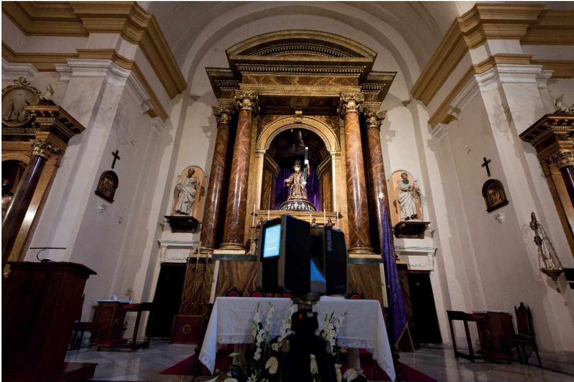
Figura 184. Toma de datos en el interior de la iglesia con el escáner faro Focus 3D Fuente: elaboración propia
