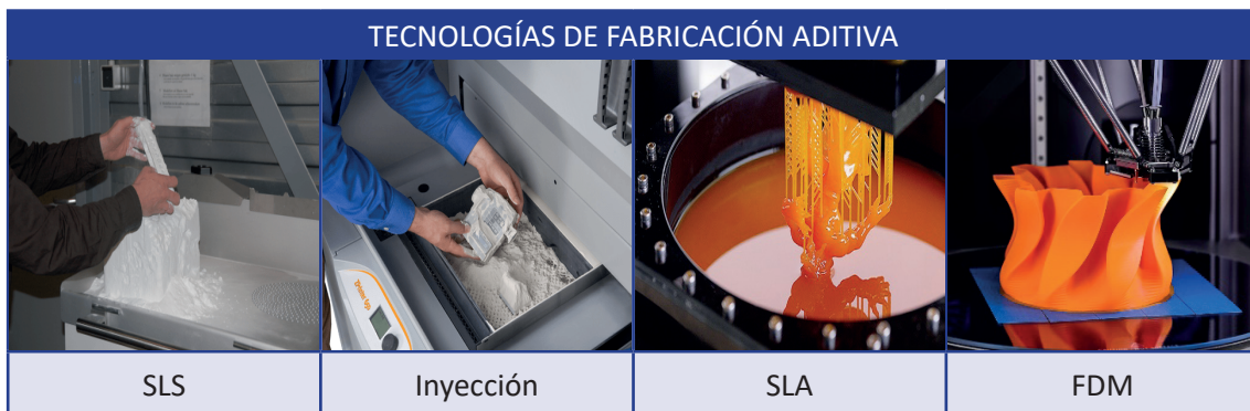
Figura 133. Diferentes tecnologías existentes de impresión 3d mediante fabricación aditiva. Fuente: imágenes Google
