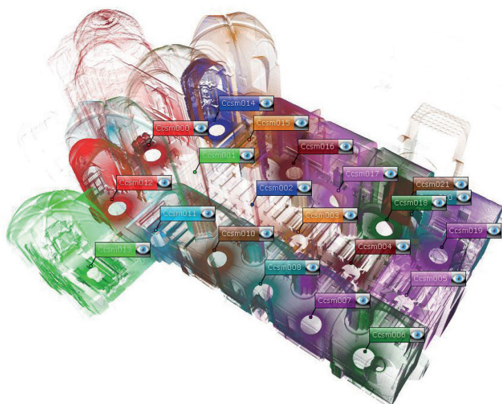
Figura 23. Modelo de nubes de puntos formado por varios escaneos. Fuente: elaboración propia
