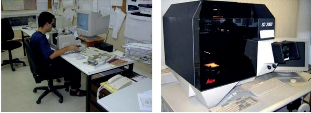
Figura 17. Restituidores. A la izquierda un Adam MPS2 (digital) y a la derecha un Leica SD2000 (analógico). Fuente: Laboratorio de Fotogrametría Arquitectónica
