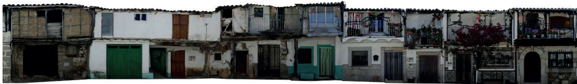
ORTOFOTO GENERADA A PARTIR DEL MODELO 3D OBTENIDO POR FOTOGAMETRÍA
