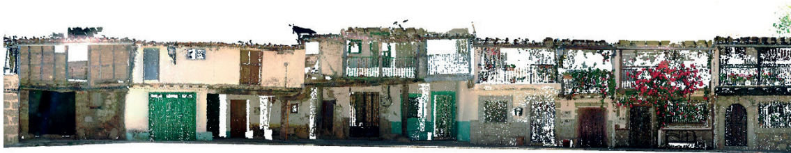
ORTOFOTO GENERADA A PARTIR DE LA NUBE DE PUNTOS OBTENIDA DEL ESCÁNER LÁSER
