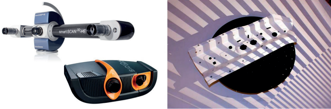
Figura 33. Escáneres de luz estructurada y ejemplo de patrón de luz. De izquierda a derecha: smartSCAN 3d HE de Breuckmann, Sidio Pro de nub3d y patrón de luz. Fuente: imágenes de Google
