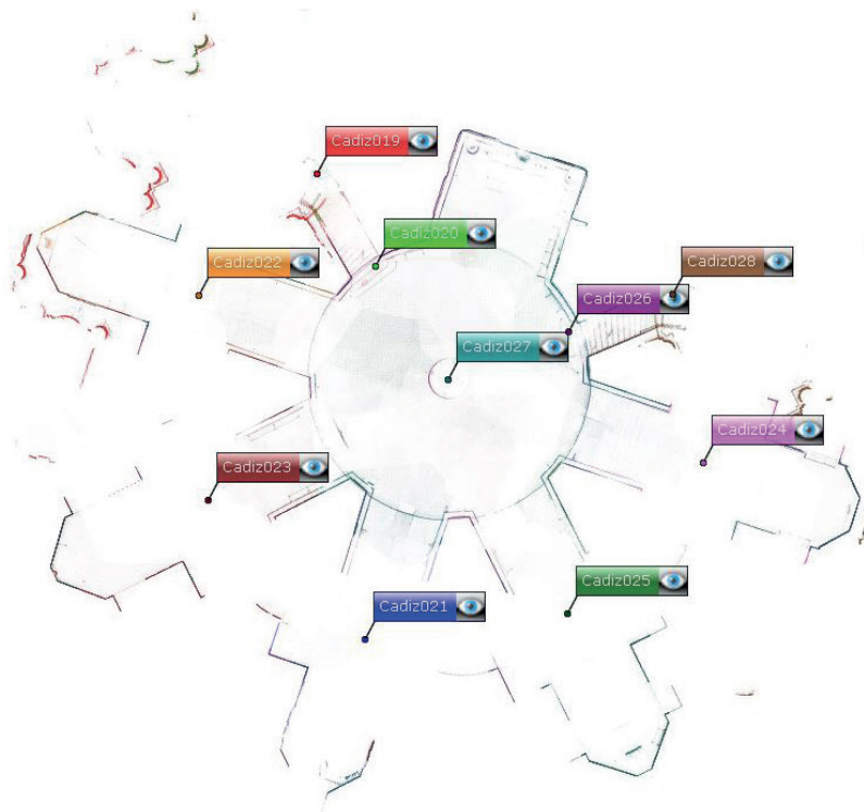
Figura 207. Distribución de los escaneos realizados en el interior de la cripta. Fuente: elaboración propia
