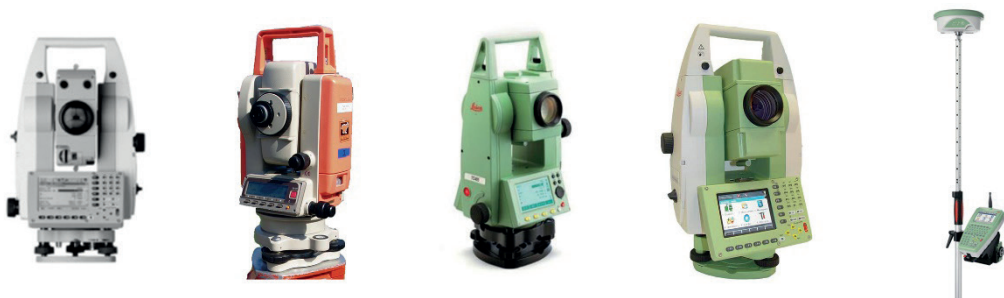
Figura 8. Evolución de los equipos topográficos. De izquierda a derecha: Pentax AL-320, Pentax PCS-1S, Leica TCR 305, Leica TCR 1200 y GPS Leica Smartrover. Fuente: elaboración propia
