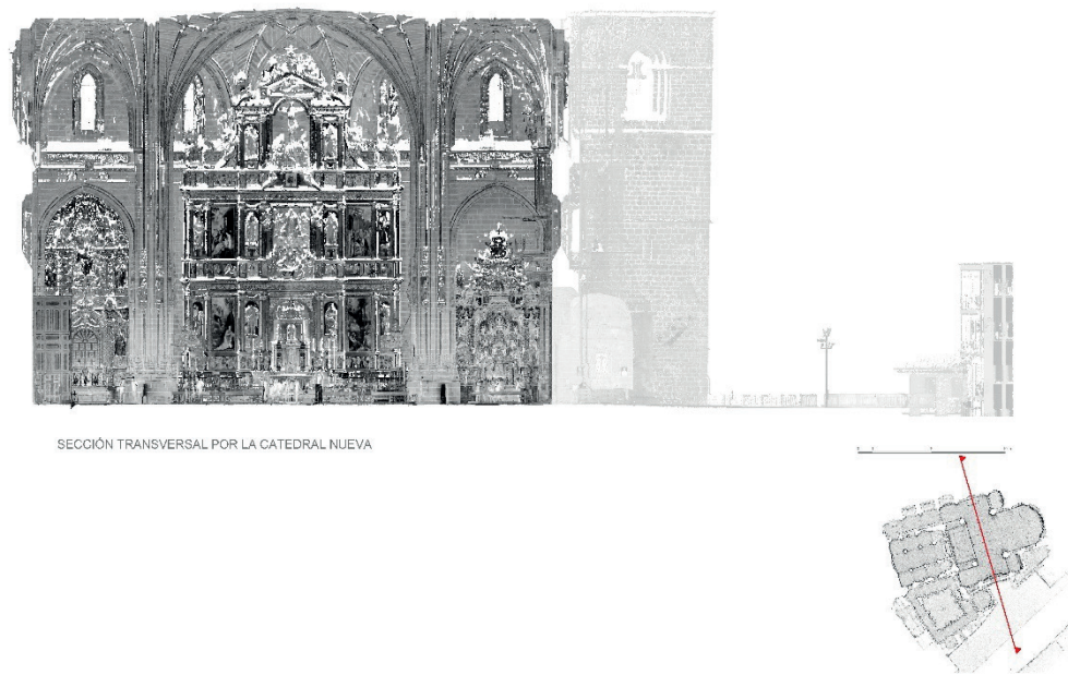
Figura 282. Sección obtenida a partir del modelo de nubes de puntos. Fuente: elaboración propia
