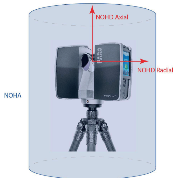
Figura 46. Cilindro virtual que define el área de riesgo ocular nominal (NOHA). Fuente: https://es-knowledge.faro.com [Consulta: 16/05/2017]
