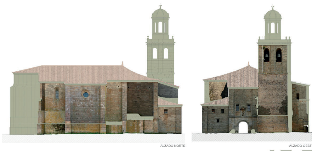
Figura 15. Alzados de fotografías rectificadas. Alzados norte y oeste de la iglesia de la Asunción en Olmillos de Sasamón. Fuente: elaboración propia
