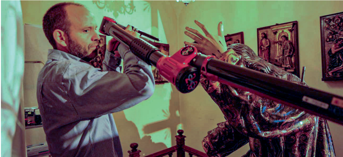
Figura 180. Proceso de escaneo de las manos en su ubicación en la talla . Fuente: elaboración propia
