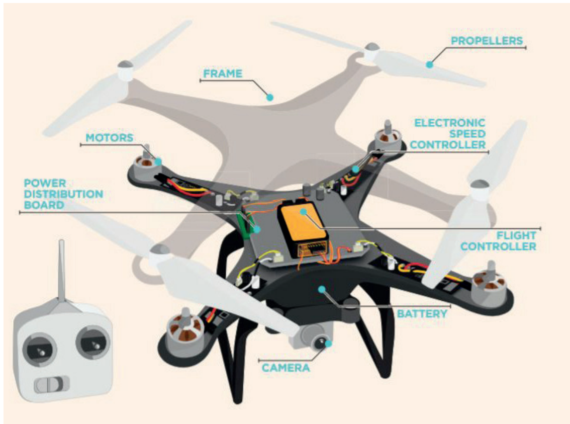
Figura 39. Esquema de los componentes internos de un dron multirotor. Fuente: https://guiadrones.com [Consultado: 26/04/2020]
