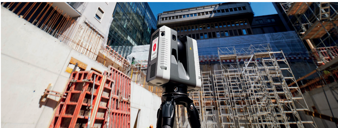
Figura 24. Escáner Leica RTC360. Imagen tomada de la web corporativa Leica Geosystems. [Consultado: 09/04/2021]
