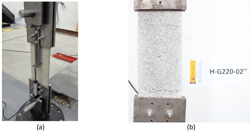
Figura 3. Ensayo de tracción de cupones TRM: (a) medición mediante LVDT; (b) medición mediante sistemas de correlación digital de imagen.
