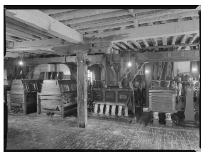
Diversas imágenes del interior de la fábrica San Antonio de Rioseco. Realizadas por Juan Miguel Pando Barrero en 1961. De izquierda a derecha, área de distribuciones, sala de plansichters, y fila de molinos de cilindros Sistema Daverio. Fuente: www.mcu.es/fototeca_patrimonio .
