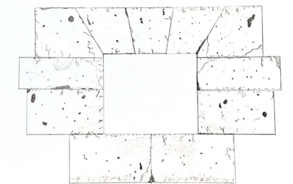
Vanos de la planta baja con sillería regular. Elaboración propia.
