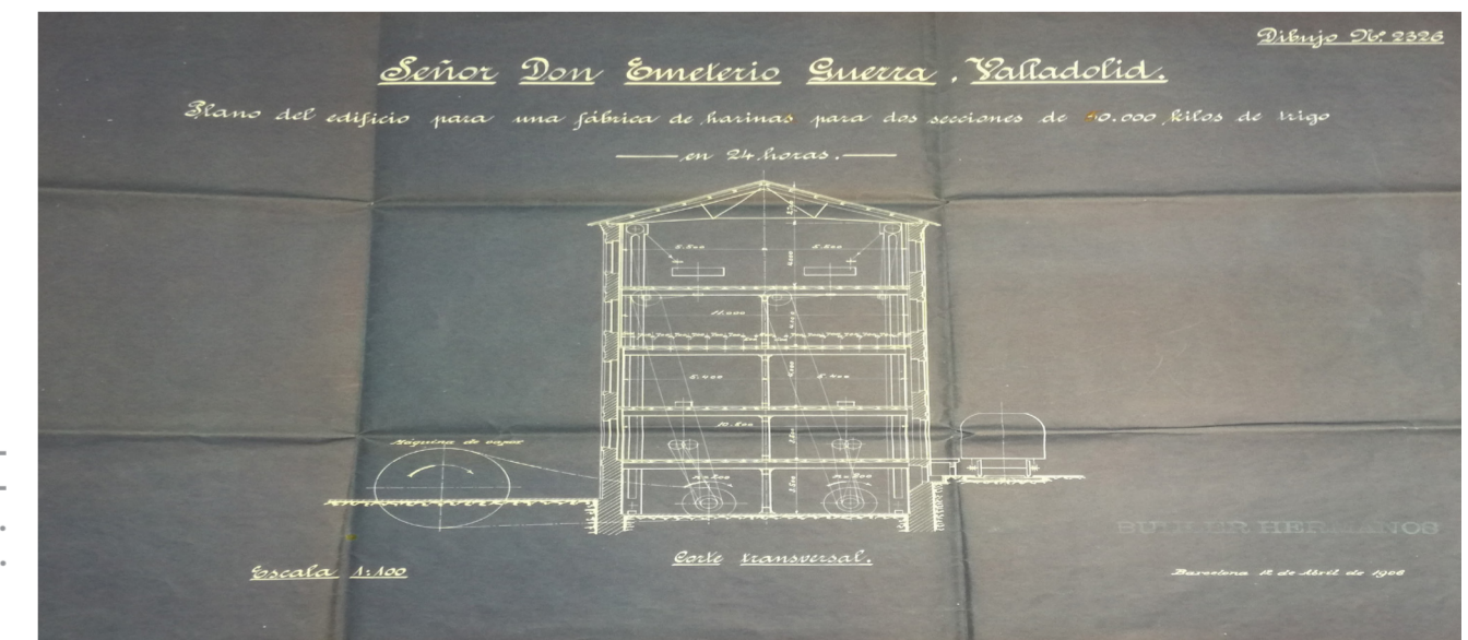
Diseño histórico de plano de la fabrica en corte transversal, de la década de 1910, con el objetivo de crear dos secciones de producción. La idea primitiva era la realización de una única línea con producción de 15.000 kg/día, pero en la década siguiente el proyecto incluye otra línea más, duplicando de este modo la capacidad total. Fuente: AHPV.
