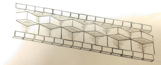
Sistemas de cornisas de remate y de cincha, herencia del siglo XIX y con prolongación en el siglo XX. Presentes en Peñafiel, Quintanilla, Pozaldez, Mota del Marqués, etc. Combinaciones a base de hiladas y sardineles, o bien de hiladas corridas con otras triscadas enrasadas. Elaboración propia.
