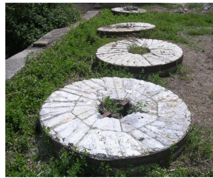
Imagen de piedras harineras desprendidas del mecanismo, con restos del anillo en el ojo y canaladuras. Olmos de Esgueva. Fuente propia.
