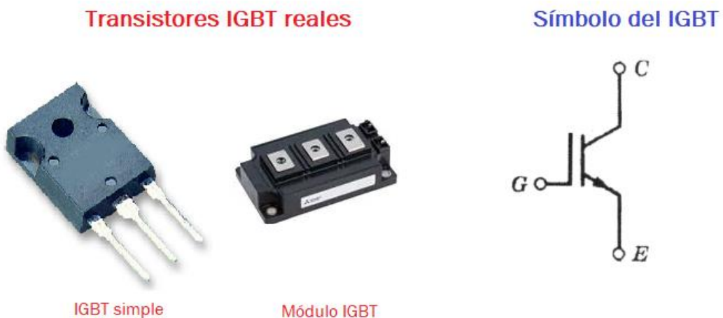
Figura 15 - Imagen de un IGBT simple, un módulo IGBT y el símbolo que representa al IGBT (16) (17)
