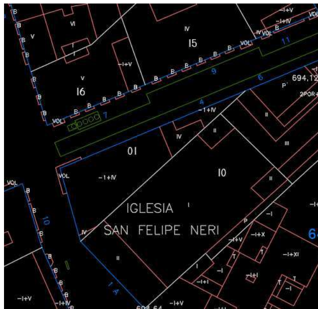
Figura 18 - Trazado del PGOU de Valladolid. En el número 7, marcado en azul en la acera, la representación del -I, indicando sótano, está casi en perpendicular con relación al eje de la calle de Regalado. Fuente: Ayuntamiento de Valladolid, 2021
