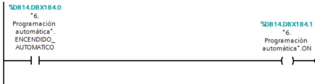
Ilustración 61. Activación modo automático
