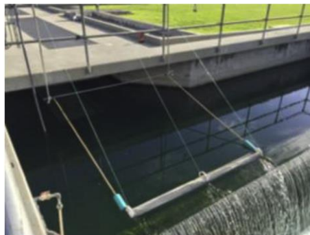
Figura 15. Sistema de toma de muestras por filtración superficial [105]
