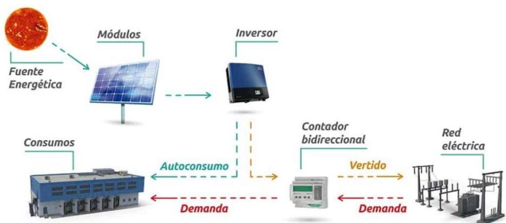
Ilustración 9. Esquema instalación de autoconsumo conectada a red. Fuente: [17]
