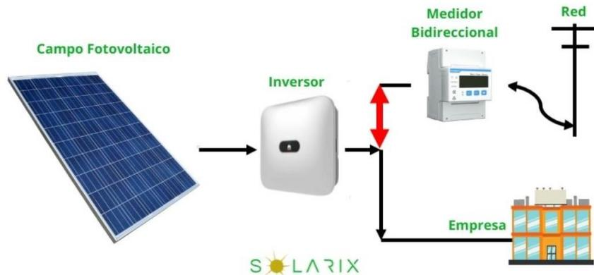
Ilustración 16. Instalación fotovoltaica de autoconsumo conectada a red.
