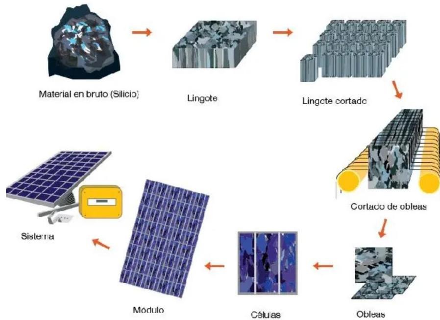
Ilustración 10. Esquema de la construcción de un panel fotovoltaico. Fuente: [10]
