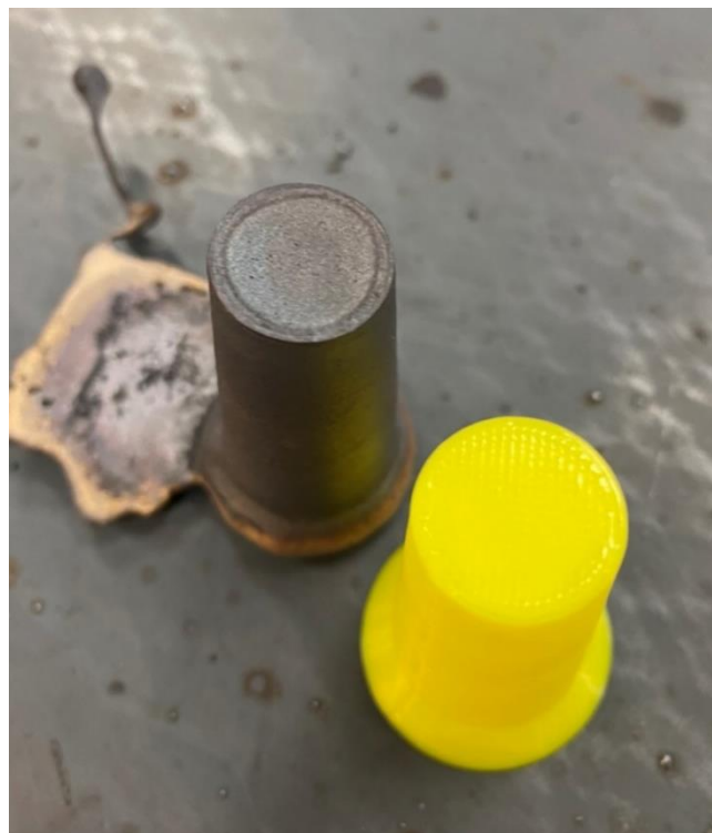
FIGURA 49. Comparación de los detalles reproducidos en la pieza final que provenían del modelo en PLA. Fuente: elaboración propia.
