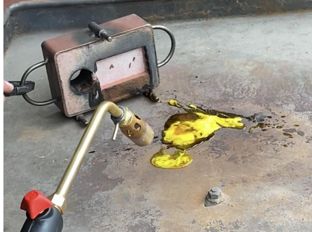
FIGURA 55. Secuencia de la fundición del modelo impreso en PLA empleando un soplete. Fuente: elaboración propia.
