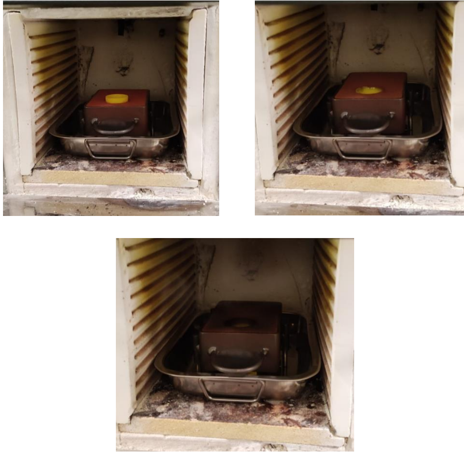
FIGURA 62. Proceso de eliminación del PLA en el horno. Fuente: elaboración propia.
