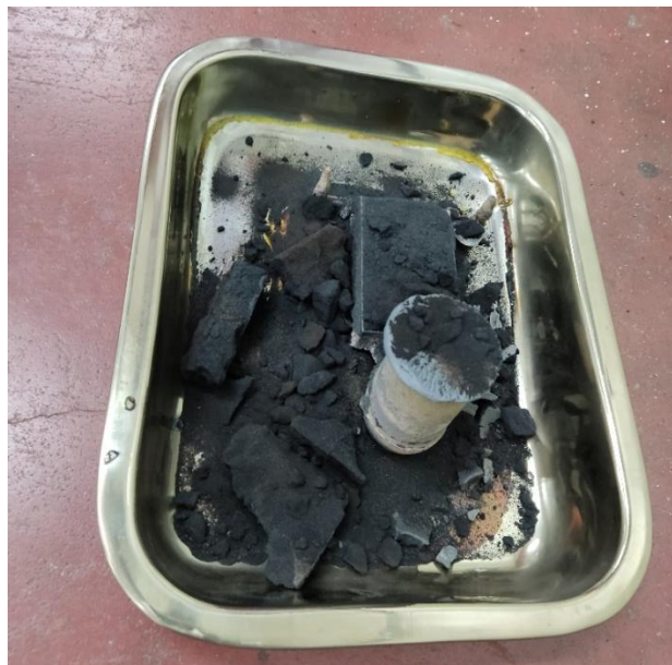
FIGURA 67. Desmoldeo de la pieza. Fuente: elaboración propia.
