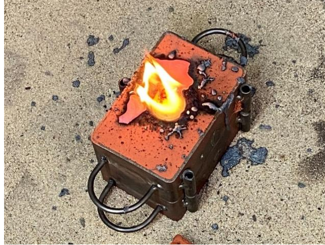
FIGURA 46. Modelo quemado tras la colada realizada. Fuente: elaboración propia.
