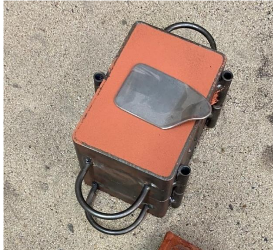
FIGURA 44. Placa que impide la entrada de impurezas al modelo. Fuente: elaboración propia.
