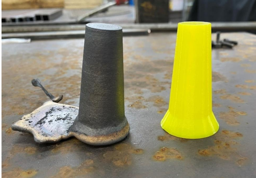
FIGURA 48. Comparación del modelo impreso en PLA y la pieza final en bronce. Fuente: elaboración propia.
