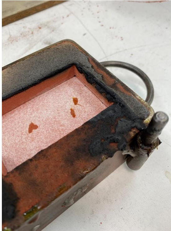
FIGURA 56. Defecto en las arenas quemadas. Fuente: elaboración propia.
