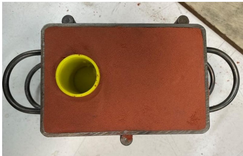
FIGURA 52. Molde completo preparado. Fuente: elaboración propia.
