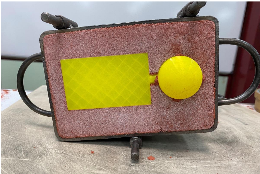
FIGURA 53. Semi molde superior junto al modelo. Fuente: elaboración propia.
