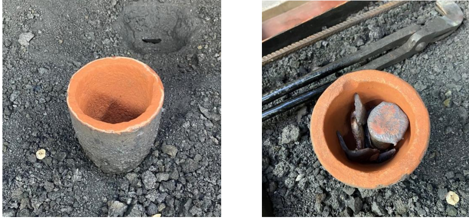
FIGURA 42. Aleación de bronce preparada en el crisol para ser fundida. Fuente: elaboración propia.
