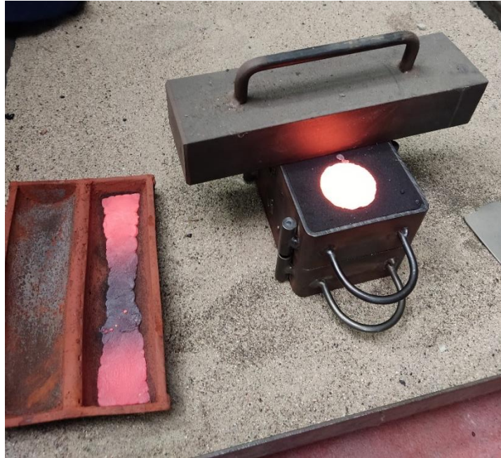
FIGURA 66. Cavity del molde rellena de la aleación de bronce. Fuente: elaboración propia.
