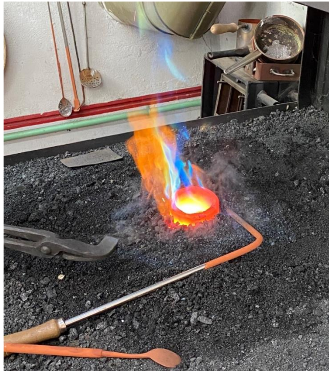
FIGURA 43. Fundición del bronce. Fuente: elaboración propia.
