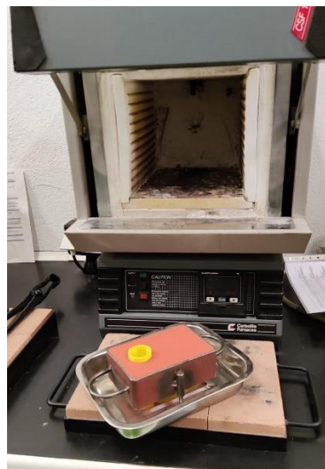
FIGURA 60. Molde preparado antes de ser introducido al horno. Fuente: elaboración propia.
