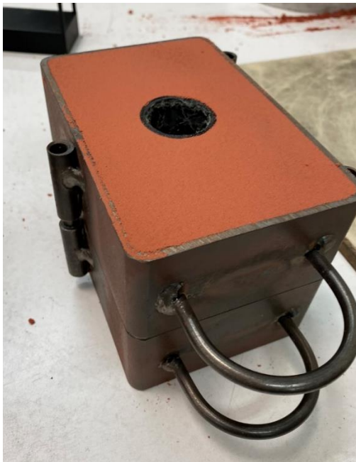
FIGURA 41. Molde preparado junto al detalle de la eliminación de material en el modelo. Fuente: elaboración propia.
