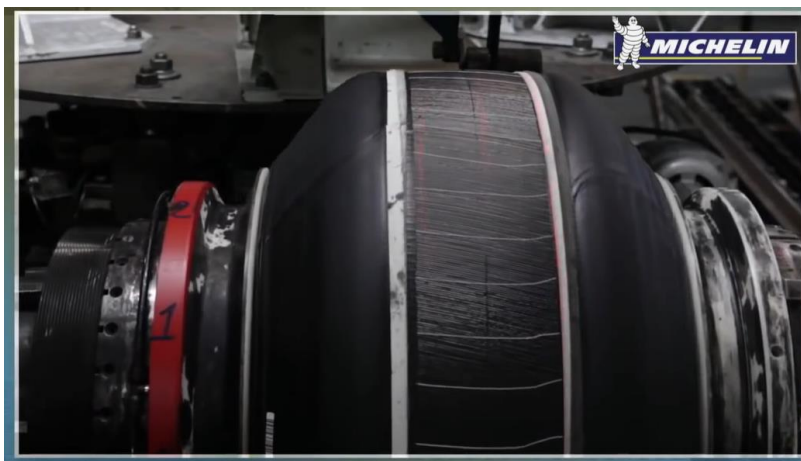
Figura 17. Conformado del Neumático. Fuente. (Motor.es, 2017).
