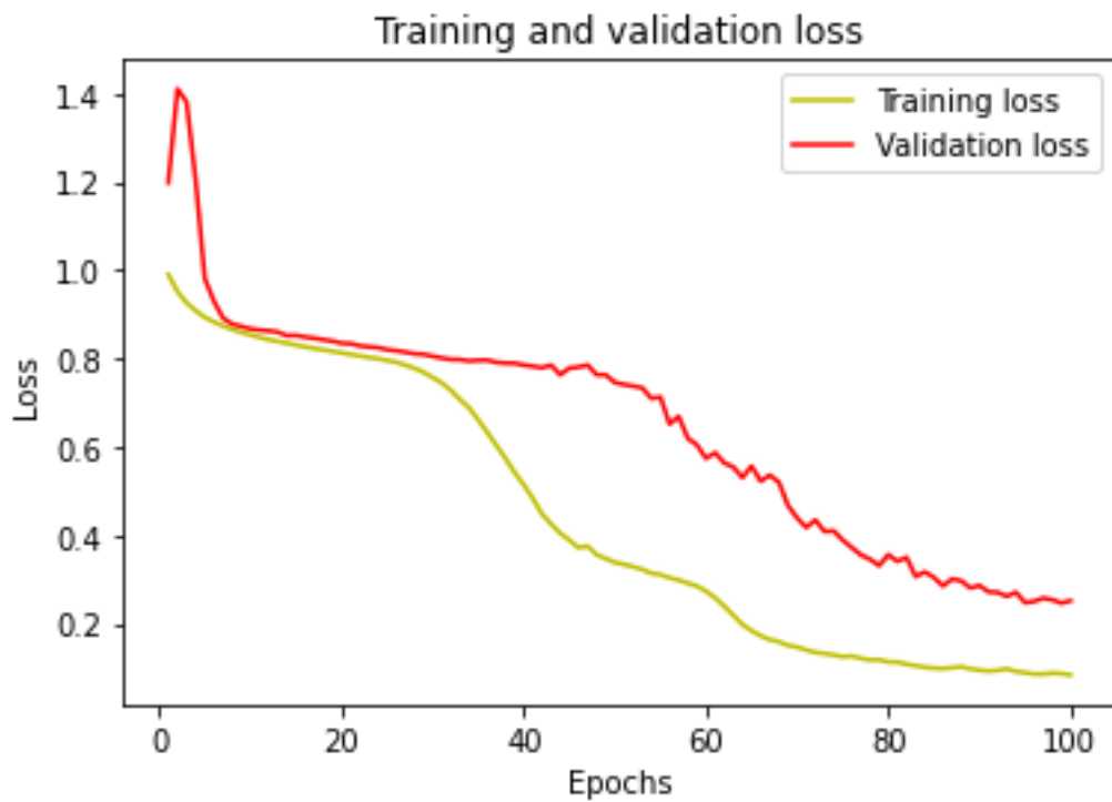
Figura 46. Representación gráfica del valor del error de entrenamiento y el error de validación por épocas. Modelo con etapa decodificadora ResNet-50
