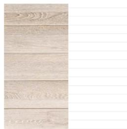
m1\_madera laminada marrón claro con franjas de 15cm de ancho colocada sobre mortero, aislante y lámina antiimpacto, utilizado en todos los espacios interiores de biblioteca, salas de investigación, pasillos y salas cerradas; con la beta marcada para cumplir con la rugosidad estipulada en el CTE.
