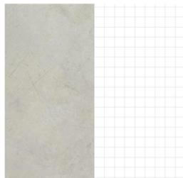
b2\_Baldosa de gres color gris claro de 15x15cm colocada sobre base de mortero y aislante, con lámina de antiimpacto, utilizada en las zonas de servicio, baños, cocinas y almacén de cocina; cumpliendo con el coeficiente mínimo de rugosidad para evitar deslizamiento y resbaladidad.
