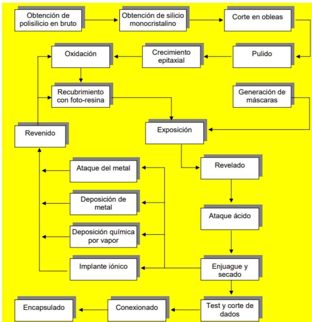
Figura 4. Proceso de producción de semiconductores (Nieto, 2020).
