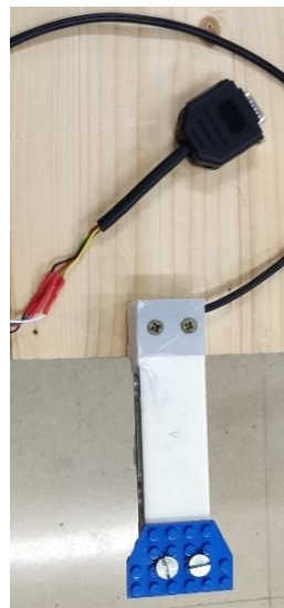
Figura IV.10. Montaje finalizado célula de carga
