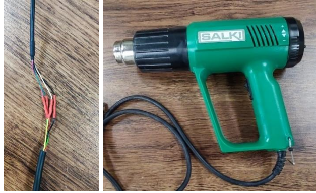
Figura IV.6. Fijación de los cables con pistola de calor
