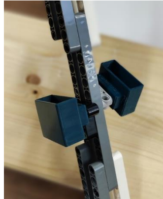
Figura IV.20. Montaje soportes para sensores en péndulo físico. Paso 5
