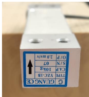
Figura II.20. Detalle de la célula de carga indicando la dirección medida
