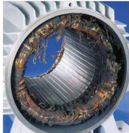
Figura 4.5. Bobinado del estátor quemado por sobrecargas térmicas. [16]
