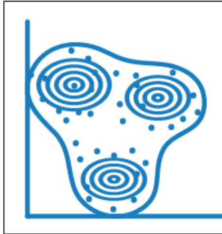
Figura 6.15. Representación del algoritmo Gaussian Mixture Model . [9]
