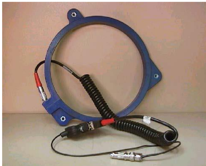
Figura 5.8. Bobina para la medida del flujo axial de dispersión [15]
