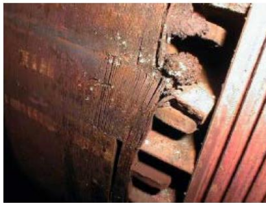
Figura 4.8. Fallo por fatiga en la unión de las barras y el anillo de cortocircuito. [14]
