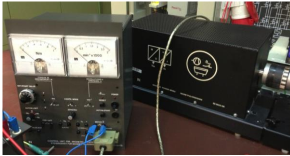
Figura A1.4. Freno de polvo magnético y unidad de control de Lucas-Nülle.
