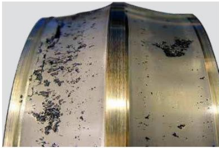
Figura 4.12. Descascarillado de la pista exterior del rodamiento debido a una incorrecta lubricación. [17]
