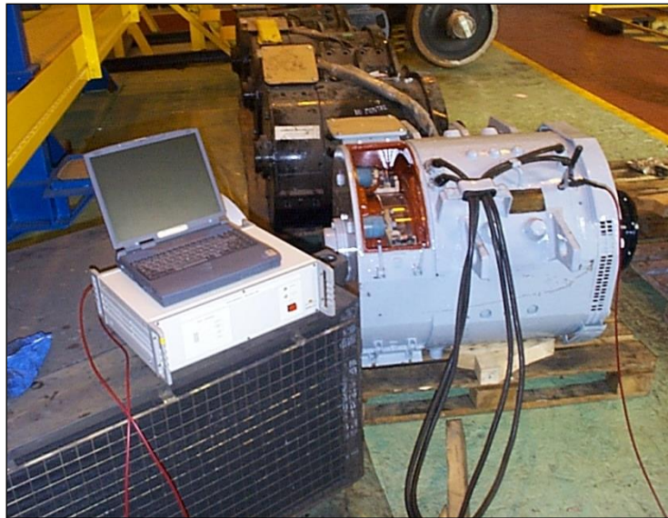
Figura 5.1. Ensayo de resistencia de aislamiento a un motor de tracción. [15]
