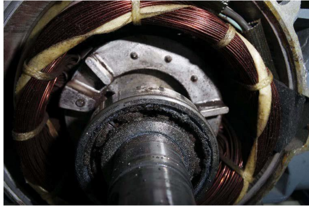
Figura 7.1. Rodamiento destrozado tras ser contaminado con SiC. [20]
