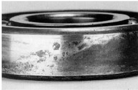
Figura 4.11. Corrosión en la pista exterior del rodamiento por vibraciones. [14]
