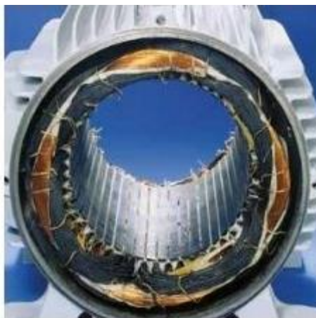
Figura 4.6. Bobinado del estátor quemado por falta en una fase. [16]
