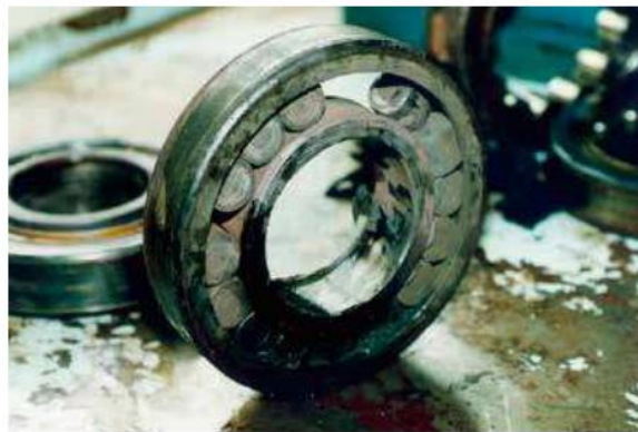
Figura 4.12. Descascarillado de la pista exterior del rodamiento debido a una incorrecta lubricación. [17]
