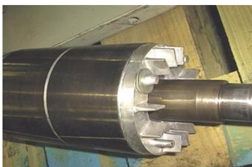
Figura 4.9. Desplazamiento del rotor del eje por un mal montaje. [15]
