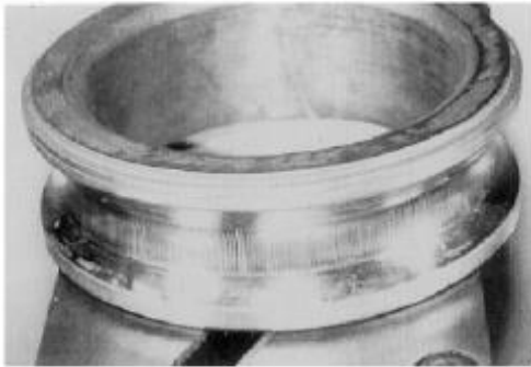
Figura 4.15. Estrías en la superficie del rodamiento por el paso de la corriente eléctrica. [14]
