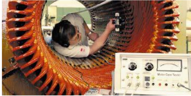
Figura 5.3. Realización del ensayo "CID" al estátor de un motor. [19]
