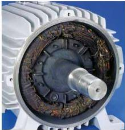
Figura 4.4. Bobinado del estátor quemado por rotor bloqueado. [16]
