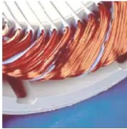
Figura 4.3. Efecto de un cortocircuito entre fases del estátor. [14]
