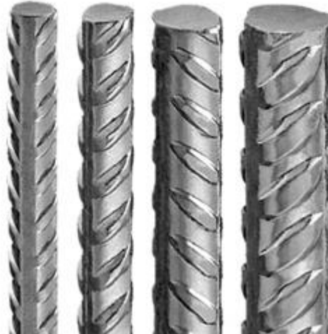
Ilustración 6 : Barras de acero corrugado. Fuente [13]
