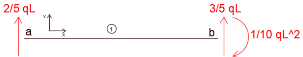
Ilustración 21 : Esfuerzos en la barra 1
