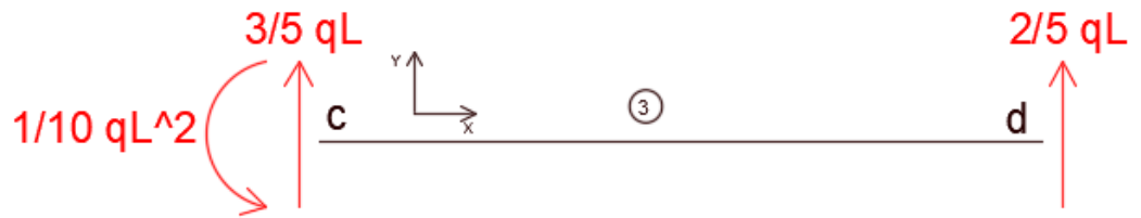
Ilustración 23 : Esfuerzos en la barra 3
