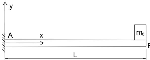
Fig. 76. Viga empotrada libre con carga en el extremo libre.
