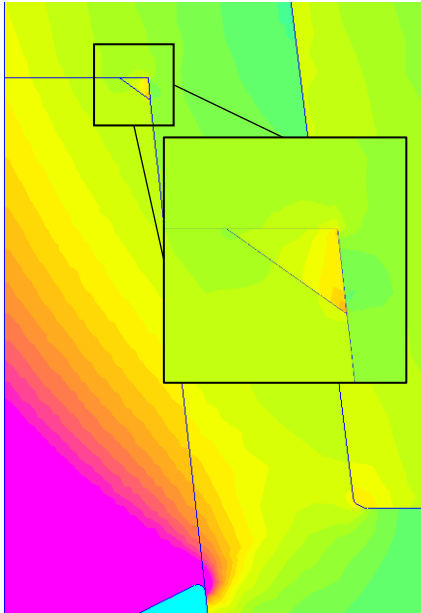
Fig. 75. Simulación del campo eléctrico del pasatapas con defecto de muesca relleno de aire. (Máx. E mostrado: 3 kV/mm)
