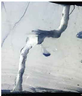
Fig. 110. Aislante perforado por burbujas con partículas semiconductoras.
