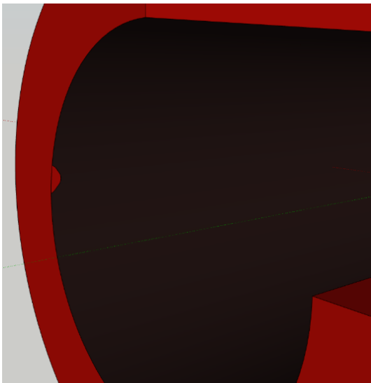
Fig. 81. Representación 3D del pasatapas con un defecto de pintura en una de las bases. Realizado con SketchUp.
