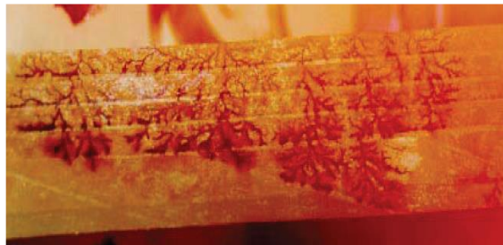
Fig. 10. Arborescencias provocadas por la degradación del aislamiento en una sección de cable aislado con papel en aceite. [28]
