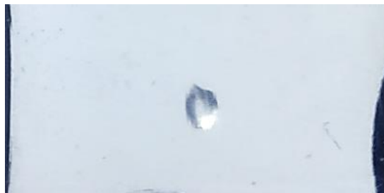
Fig. 85. Burbuja de aire atrapada en un aislamiento de silicona.
