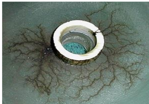
Fig. 9. Degradación en aislamiento de un cable subterráneo. [29]
