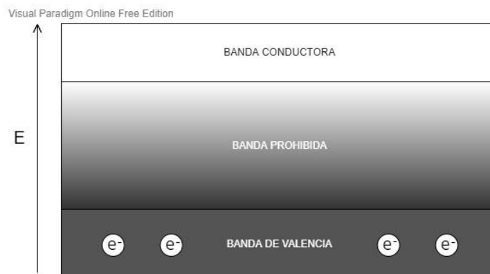
Fig. 3. Ilustración de la distribución de bandas en un aislante según la teoría de bandas.
