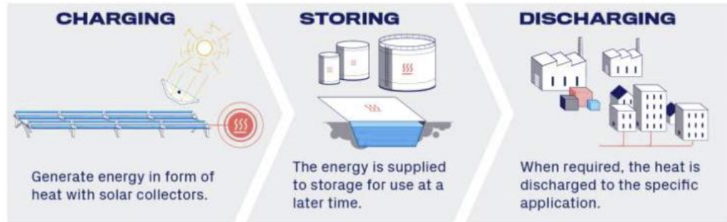
Figura 4.6: Proceso de almacenamiento de energía en forma de energía térmica.
