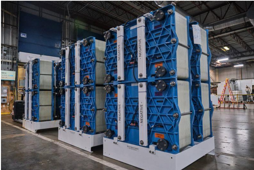
Figura 5.16: Batería de flujo de Hierro fabricada por ESS Inc.
