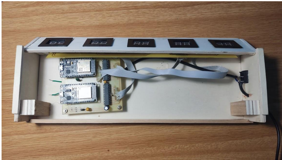
Ilustración 192: Placas de circuito impreso finales y maqueta que las contiene.
