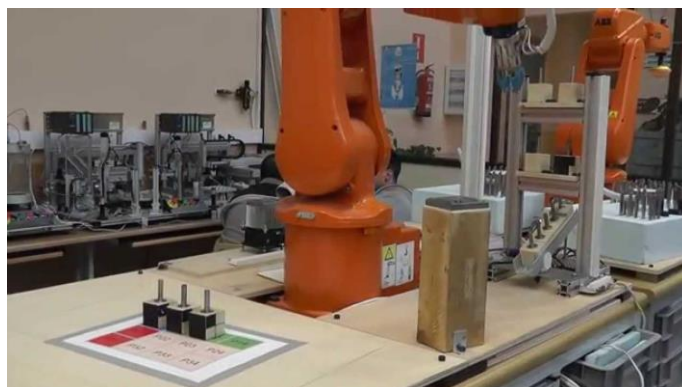
Ilustración 2: PICK & PLACE con ROBOT INDUSTRIAL ABB IRB120.[4].
