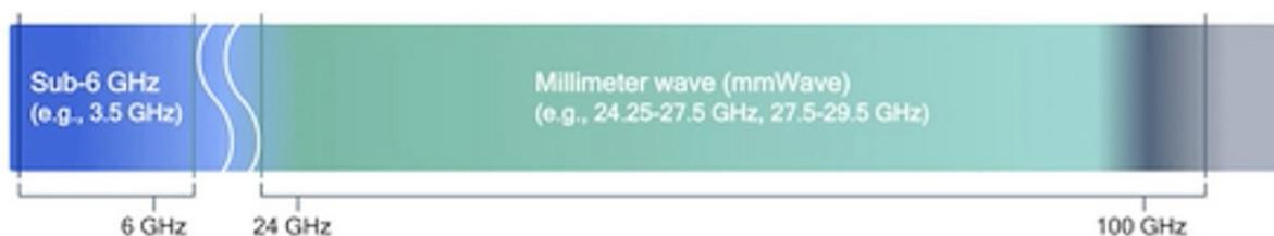
Figura 1.17: Ondas milimétricas en el espectro radioeléctrico
