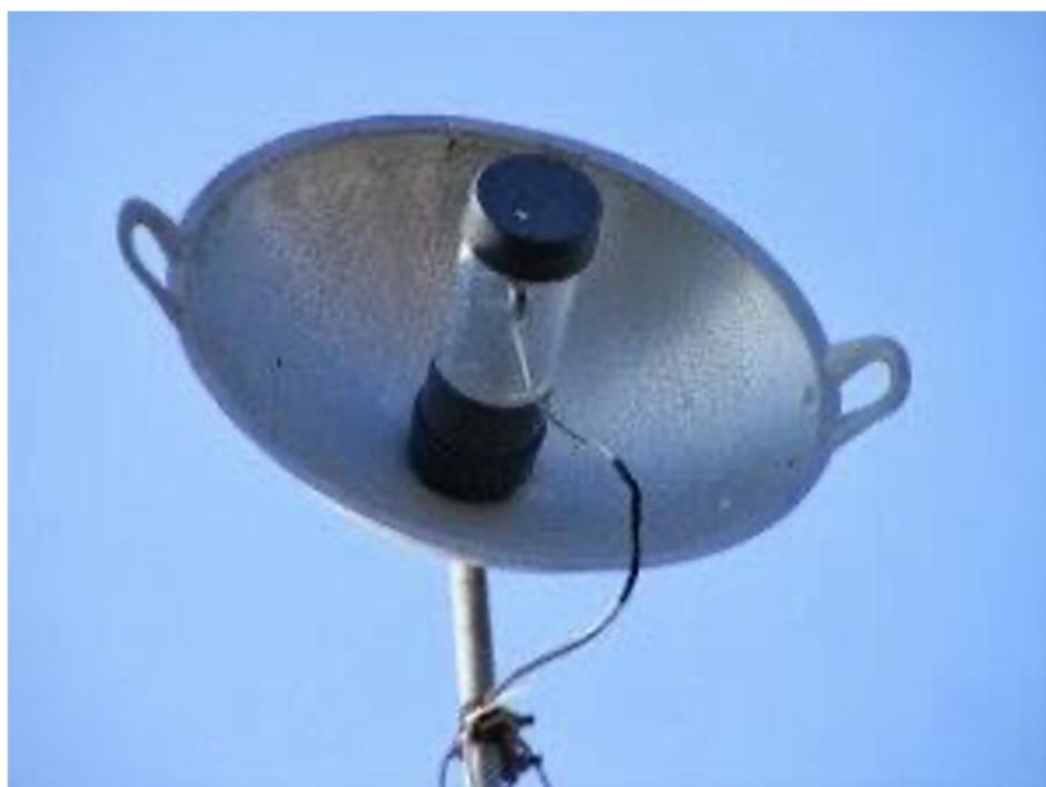
Figura 1.18: Antena parabólica construida con un Wok
