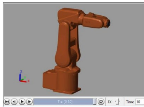
Ilustración 13. Animación de un robot obtenido con Simscape Multibody
