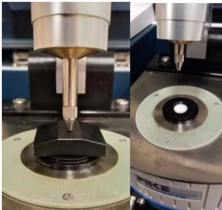
Figura 8. Montaje del complemento ATR para la medida de leche con la técnica FTIR
