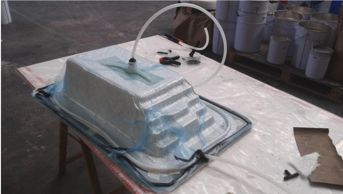
Figura 19. Molde por proceso de Infusión por vacío.
