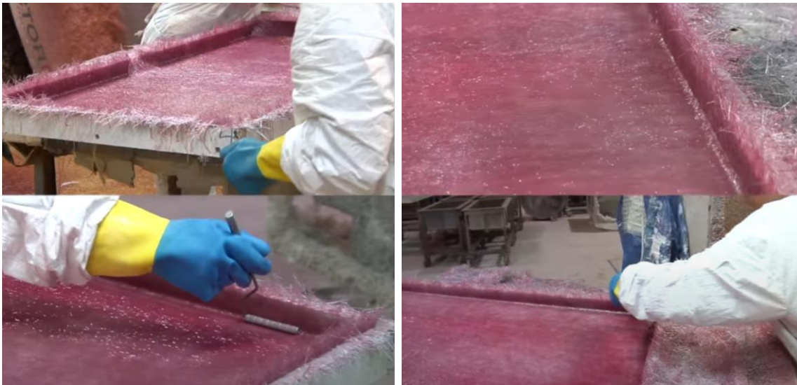
Figura 21. Proceso de fabricación por Hand Lay-Up.
