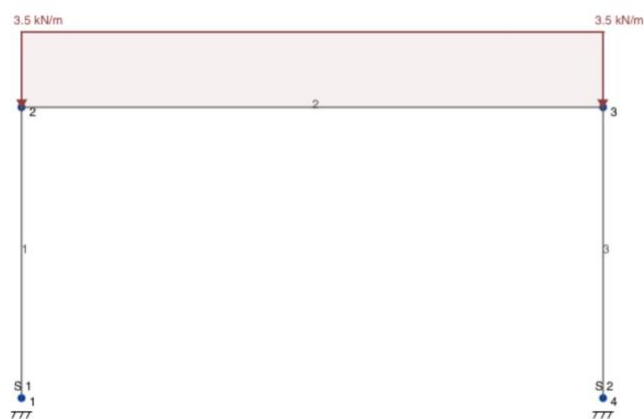
Ilustración 56 Carga distribuida Nieve (Pórtico interior 1)
