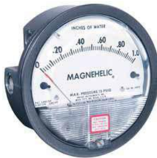
Figura 3.15. Manómetro diferencial Magnehelic usado para comprobación visual de la presión diferencial. Obtenida de [18].
