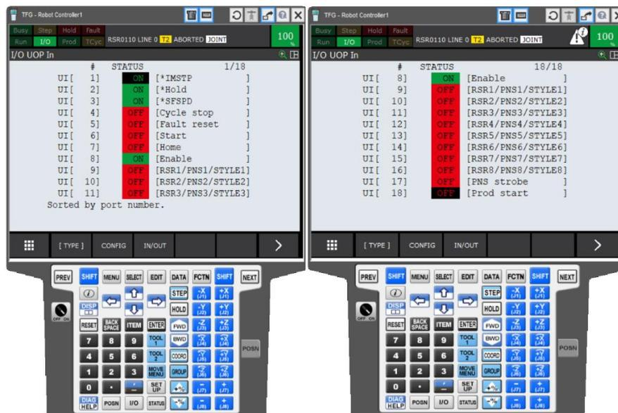
Figura 104. Configuración de señales de entrada UOP.
