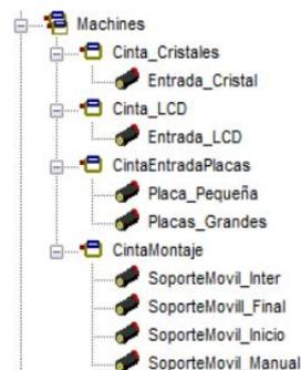
La categoría machines agrupa dispositivos de movimiento generalmente servo motorizados con diferentes funcionalidades. Este tipo de dispositivo puede referirse a un eje externo de movimiento de uno de los robots o a sistemas externos, no relacionados con el robot, dedicados al movimiento de otros componentes que forman parte de la instalación.
