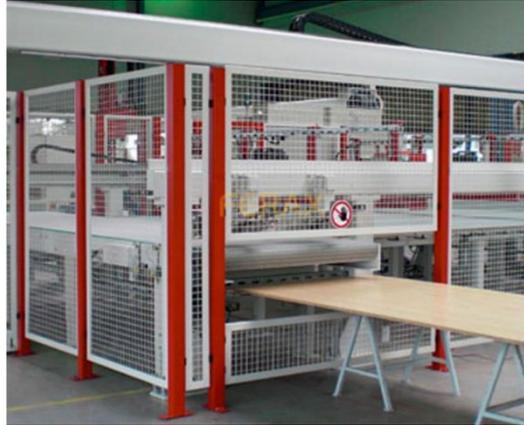
**Figura 54.** Vallado de seguridad en una instalación industrial.
