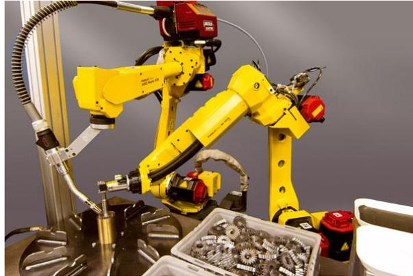
Figura 17. Trabajo conjunto coordinado mediante Multi Group Motion.
