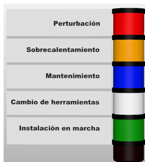
Ilustración 44. Columna de señalización.
