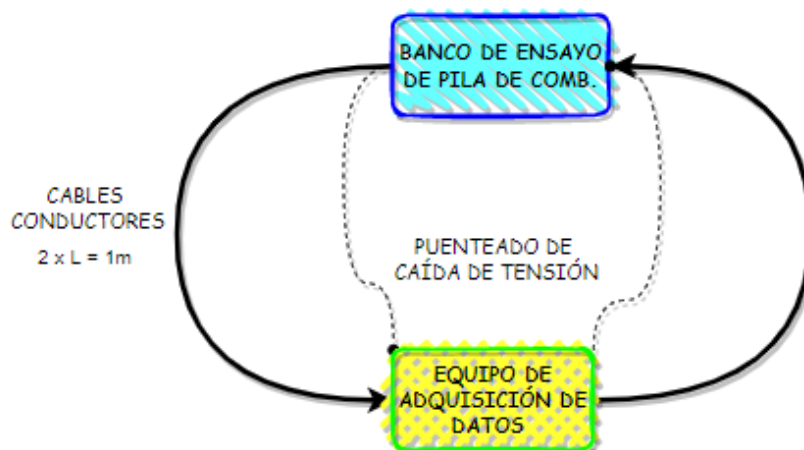
Ilustración 22: Montaje instalación eléctrica
