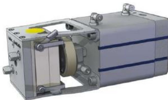
Ilustración 19: Sistema de ensayo neumático 7x7cm. Fuente: Baltic Fuel Cells. (2008). INTRODUCTION TO QUICK CONNECT FIXTURE
