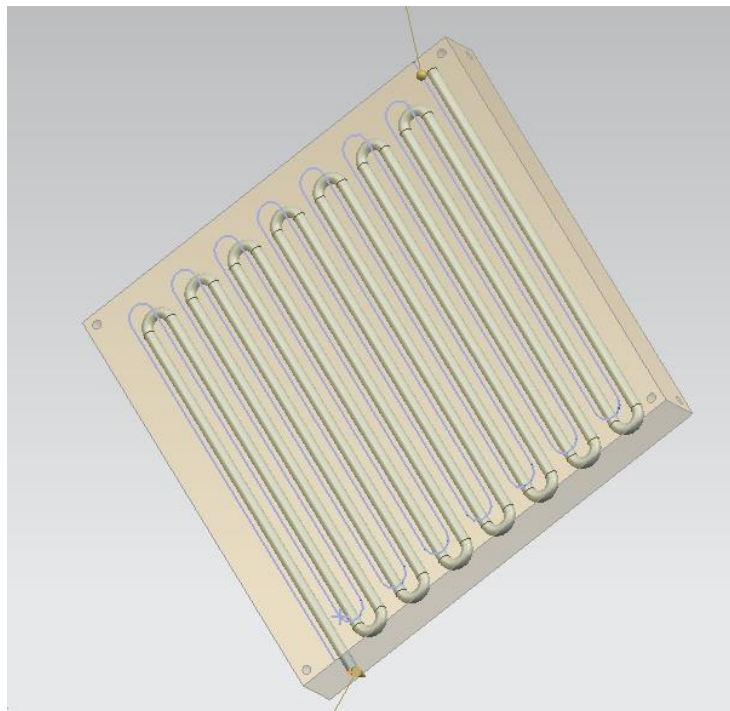
Ilustración 65: Serpentin de refrigeración
