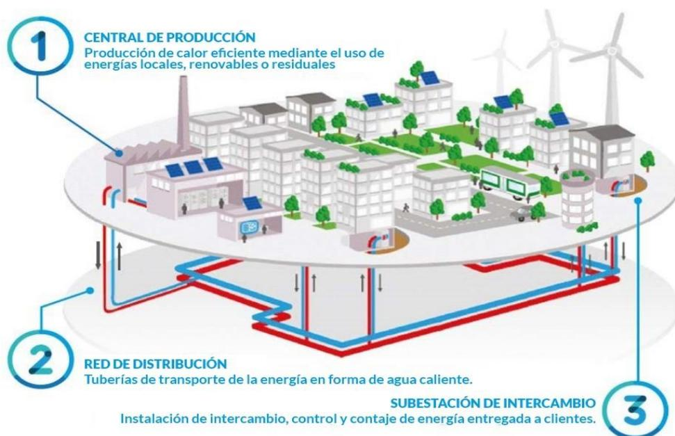
Ilustración 5. Esquema de una red de calor urbana.
