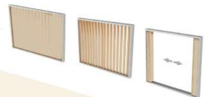
TIPOLOGIA DE LAMAS MOVILES CON LOS TRES TIPOS DE POSICIONES
