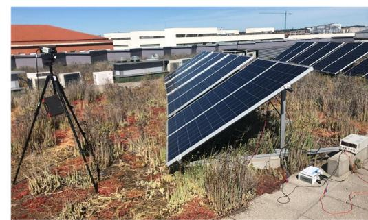
Medidas EL con polarización mediante fuente de alimentación (Tramo 2)
