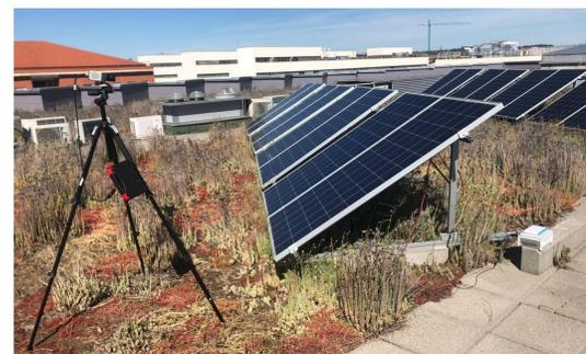
Medidas EL con polarización mediante inversor bidireccional (Tramo 3)
