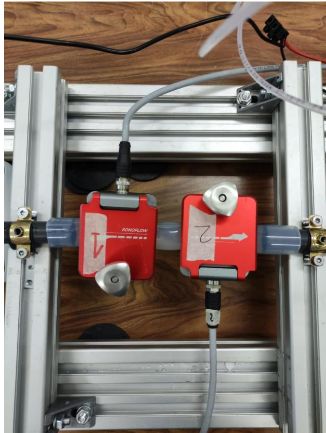
Figura 17 Caudalímetros unidireccionales, orientados en la dirección negativa (1) y positiva (2).
