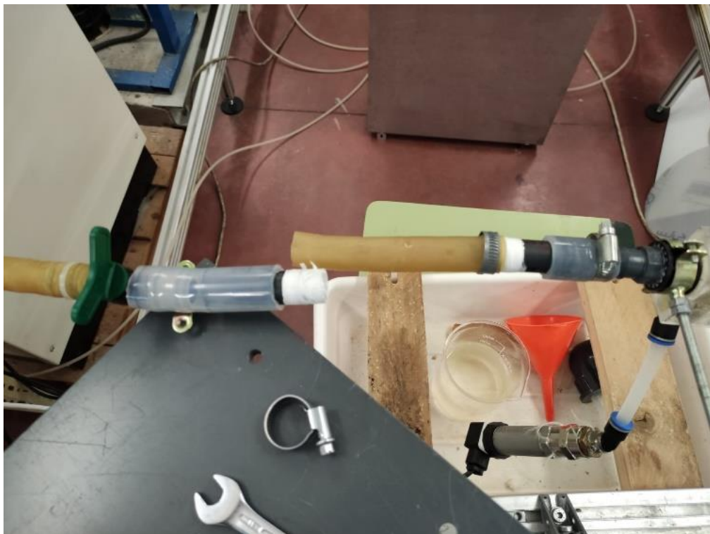
Figura 11 Montaje del tubo de látex para su caracterización.
