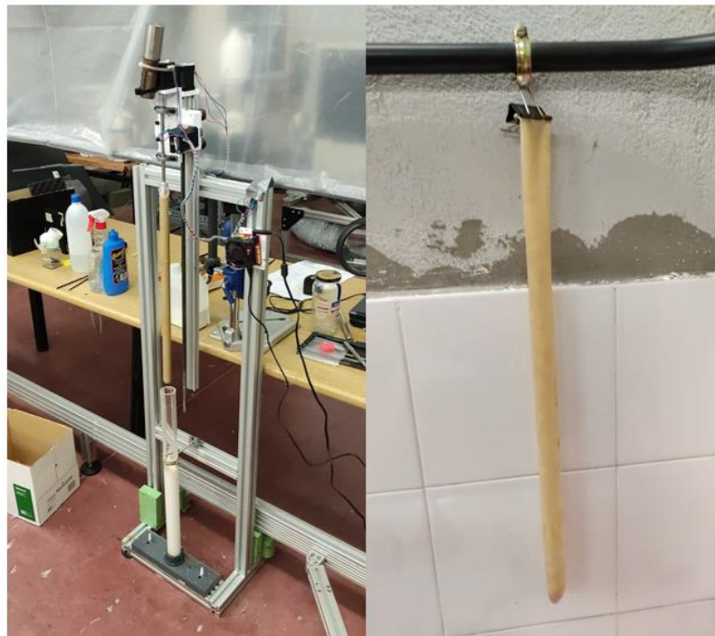
Figura 6 Robot de fabricación de tubos de látex y tubo fabricado sin cortar.
