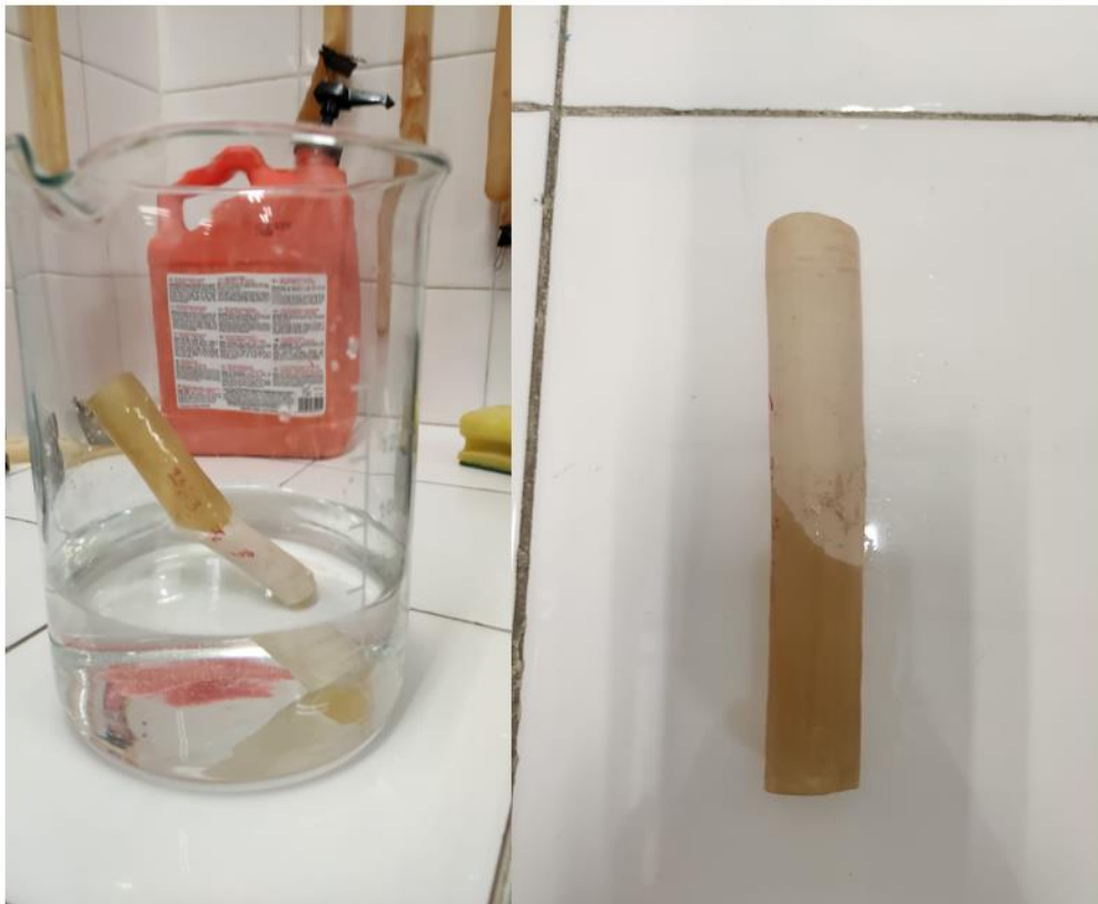
Figura 36 Efecto de sumergir parcialmente un tubo de látex durante dos días. Nótese el contraste en el color, al blanquearse la parte sumergida. Al tacto también se notan diferencias, siendo la parte sumergida más suave y flexible.
