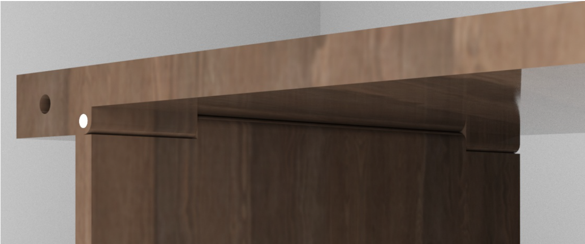
Fig.67: Vista de detalle del giro de la pata. Elaboración propia
