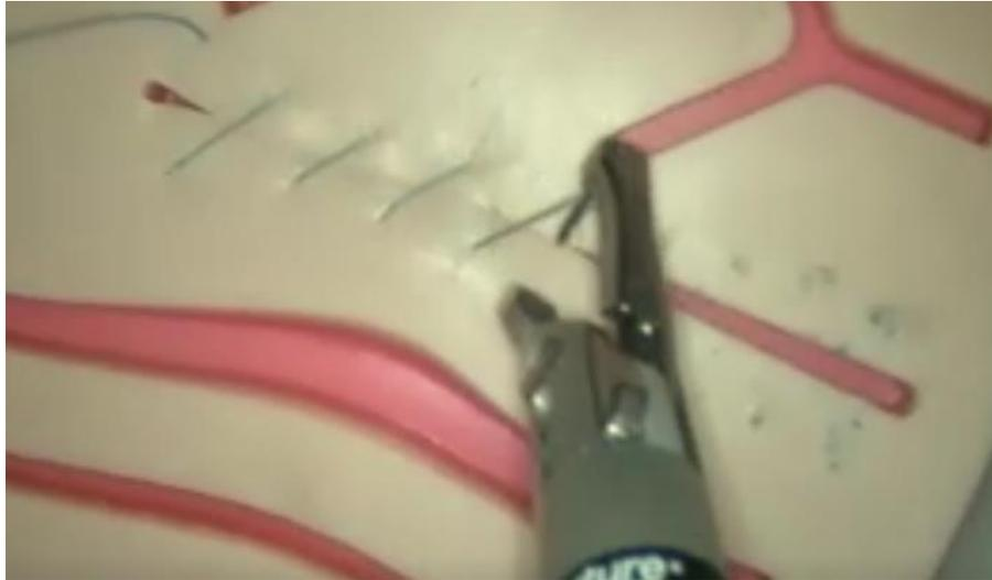
Figura 4 Herramienta de sutura para cirugía laparoscópica.. Sutura realizada sobre una réplica de tejido en silicona. Fuente: ITAP Uva
