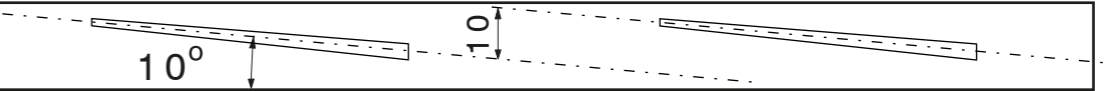
Esquema de desarrollo de la rosca interior proyectada sobre el cilindro base (2 hilos)
