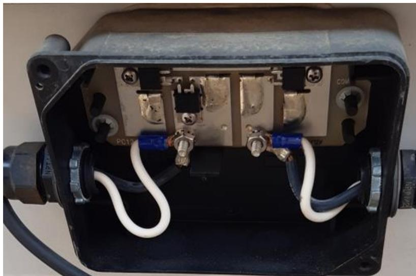
*Figura 45: Conexión de los transductores de tensión en los bornes positivo y negativo de las placas. Fuente: Fundación CARTIF*
