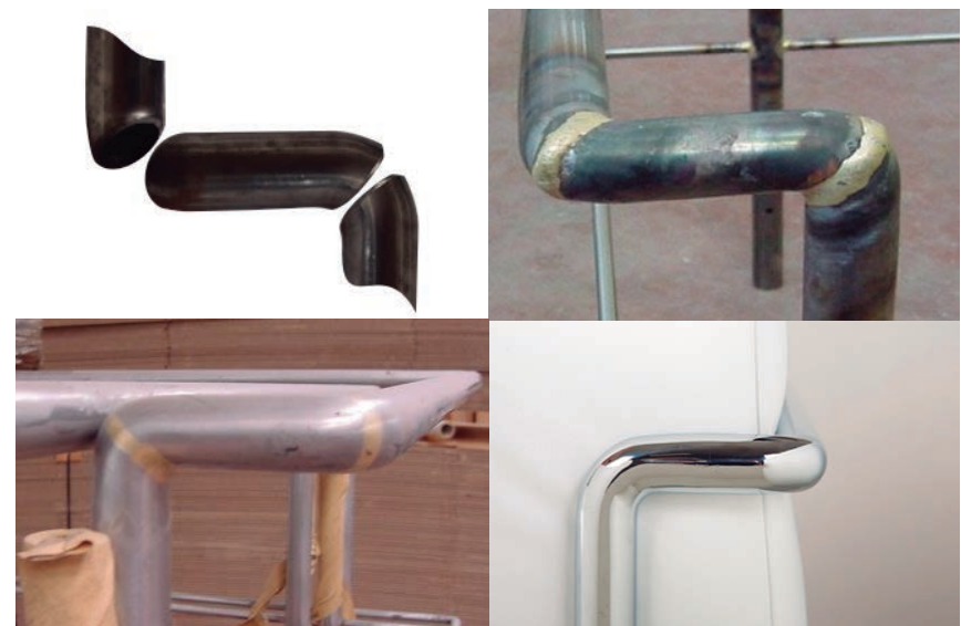
F124 Proceso de configuración del marco de metal, Steeldomus
