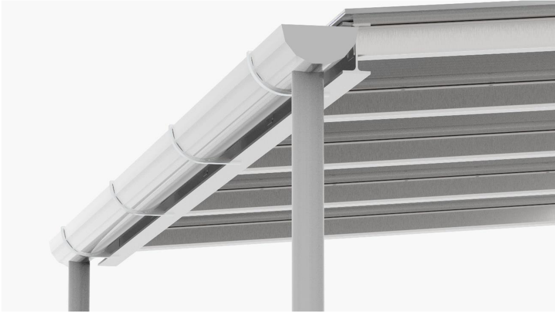
Fig 90. Detalle del canalón
