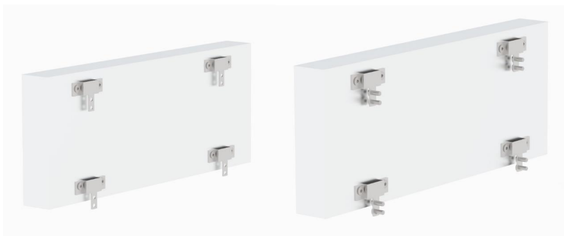
Fig 114. Detalle colocación de los tornillos de anclaje de la pantalla a la carcasa
