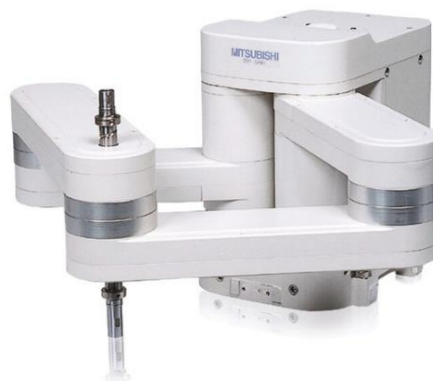
Figura 9: robot paralelo SCARA dual arm de 4 GDL [20]
