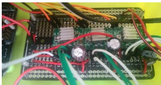
Figura 20: stripboard utilizada en este proyecto con los componentes necesarios ya soldados en ella.
