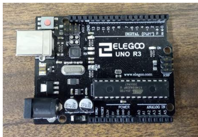
Figura 16: placa de electrónica ELEGOO UNO R3 usada en este proyecto
