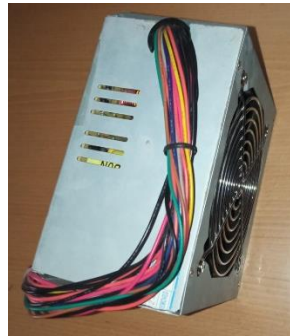
Figura 17: ejemplo de una típica fuente de alimentación que se puede extraer de un ordenador
