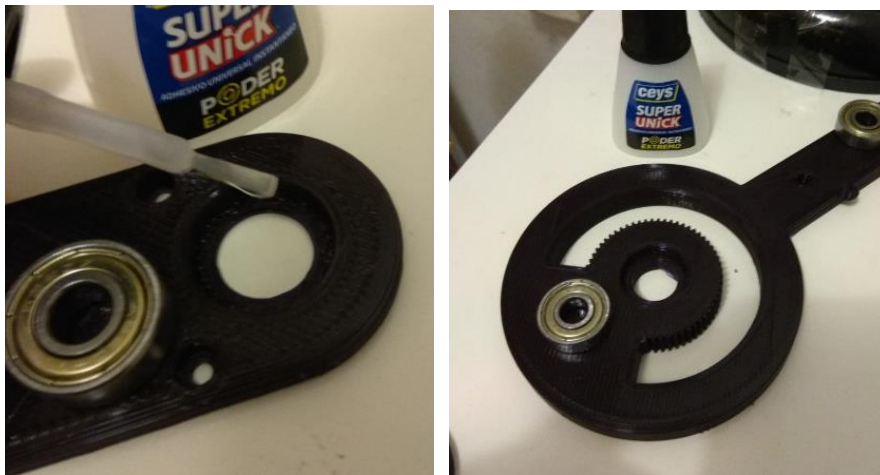
Figuras 60 y 61: aplicación del adhesivo entre el anillo exterior de los rodamientos y las piezas de impresión 3D
