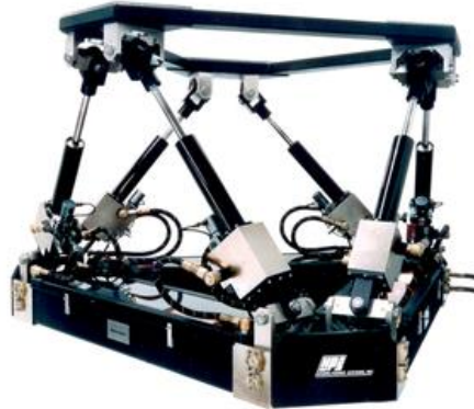
Figura 10: ejemplo de plataforma Stewart - Gough [4]
