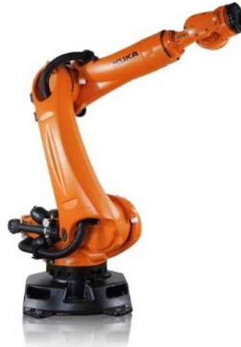
Figura 5: robot articulado con 5 GDL [20]
