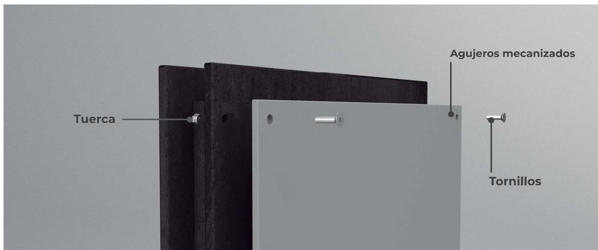
fig. 108. Detalle unión totem con panel DIBOND vertical. Uniones con tornillos y tuercas. Agujeros mecanizados
