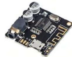
Fig. 127. Módulo receptor bluetooth
