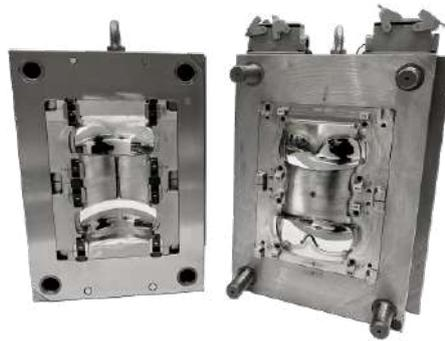
Fig. 88. Ejemplo molde de acero para inyección
