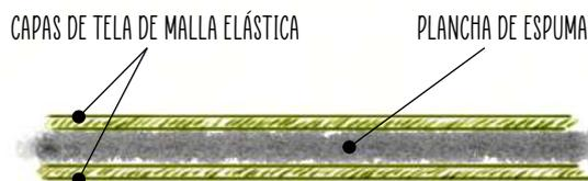
Fig. 83. Esquema capas de la pieza elástica
