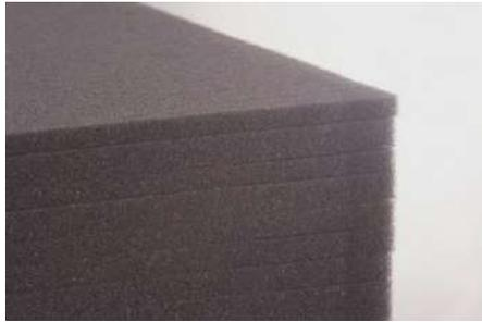
Fig. 96. Planchas de espuma PUR apiladas
