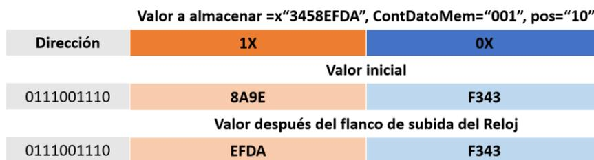
Ilustración 22: Ejemplo de cómo se almacenarán dos bytes en una dirección de memoria dependiendo de la posición.
