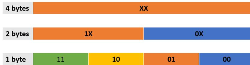
Ilustración 21: Diagrama de las posiciones que ocupan los bytes dependiendo de la dirección y la cantidad de bytes con la que se trabaje.
