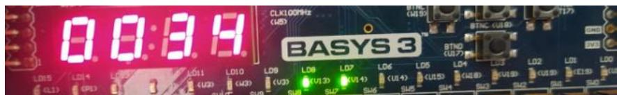
Ilustración 44: Fotografía señales de control de la instrucción 52 (34 hexadecimal).
