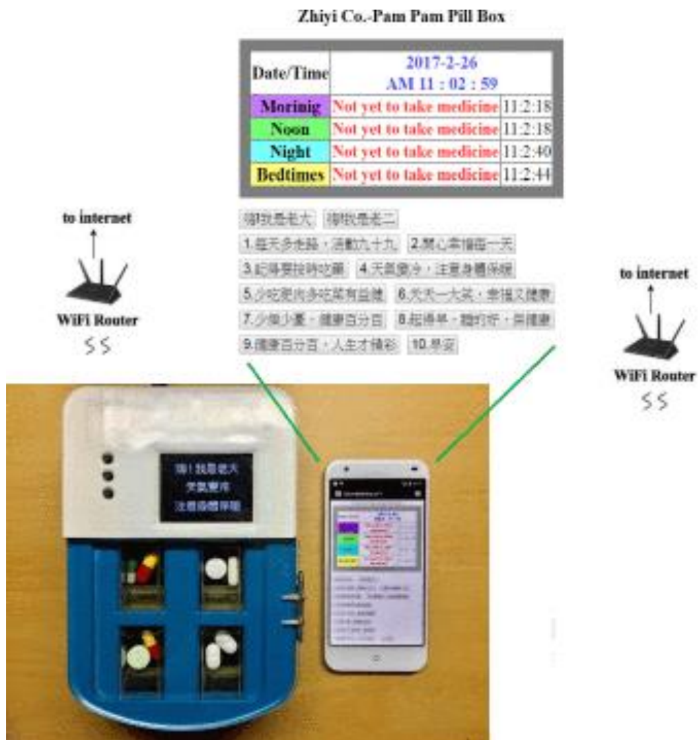
Ilustración 10 - Esquema de interconexión del pastillero con comunicación bidireccional
