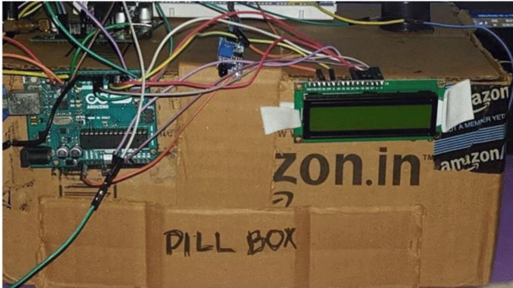
Ilustración 5 - Detalle del prototipo de caja-pastillero
