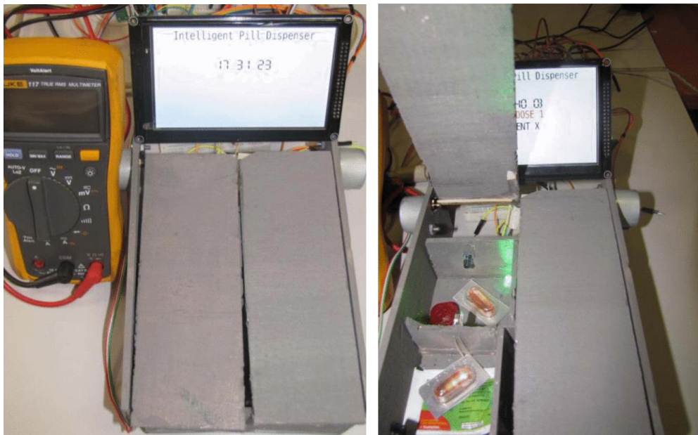
Ilustración 3 - Detalle del prototipo de pastillero
