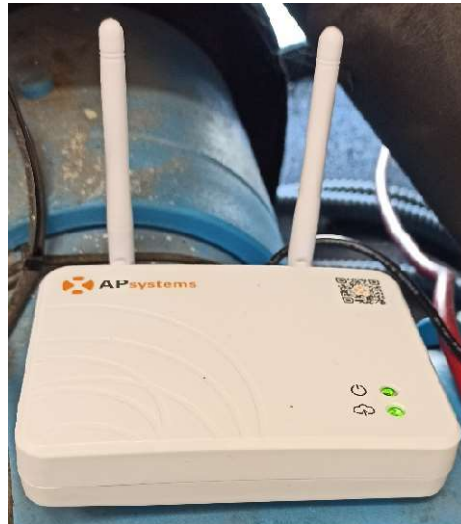
Figura 17. Imagen del router ECU-R en la instalación.
