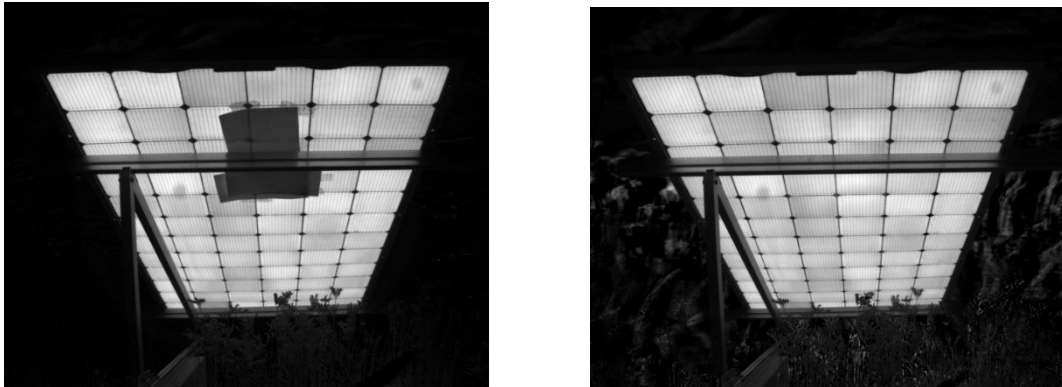
Figura 25. Prueba de fotoluminiscencia en la cara trasera de ambos paneles.
