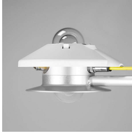
Figura 8. Fotografía de un albedómetro.
