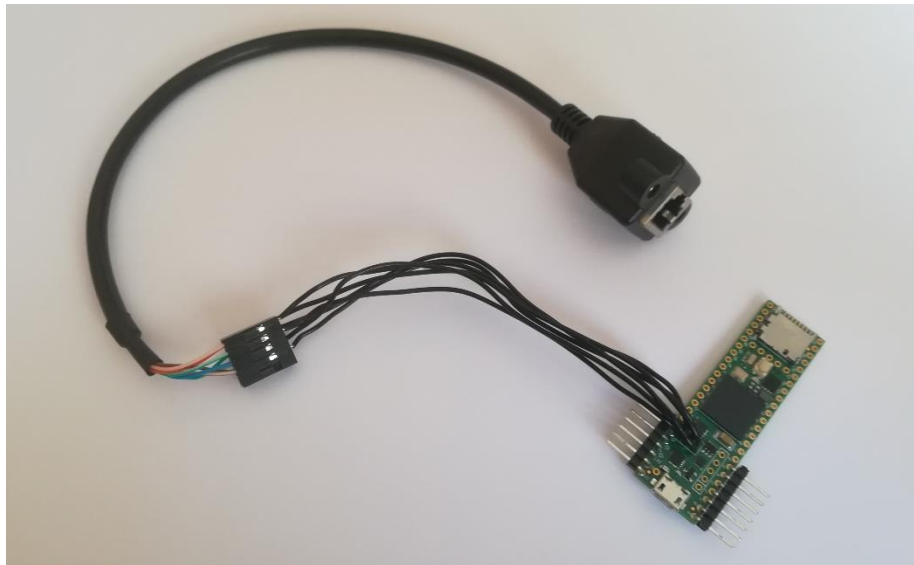
Figura 26 Conexión del puerto Ethernet al Teensy
