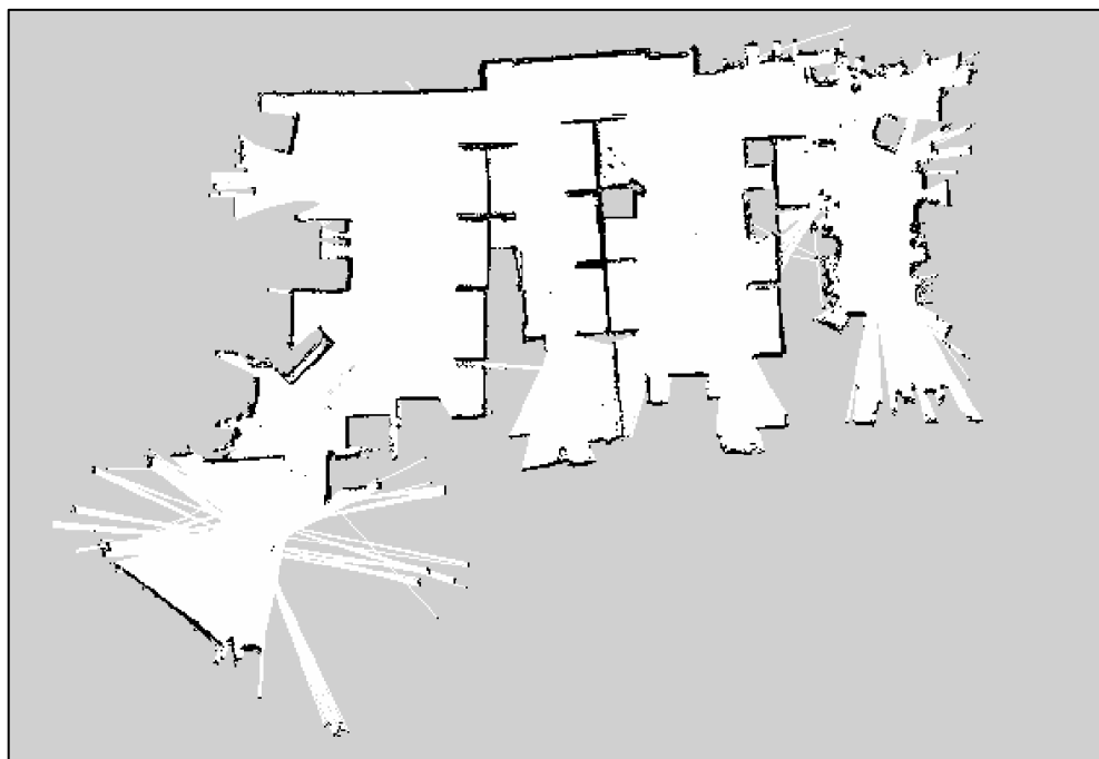
Ilustración 38 Mapa realizado por el sensor LiDAR "Hokuyo"
